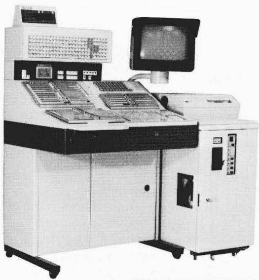
図21 日本国有鉄道納め座席予約発券用端末装置の外観
