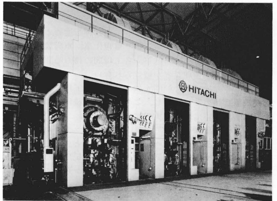
図3 連続4スタンドタンデムミル 全スタンドにHC-MILLを配置し、焼鈍ラインと直結した4スタンドタンデムミルでは、HC-MILLの効果が最大限に発揮されている。
