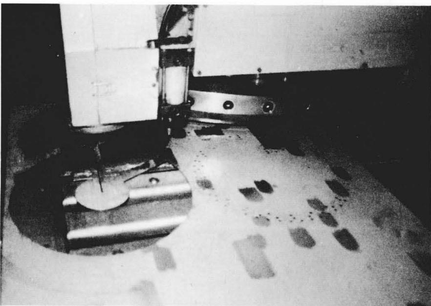
図8 NCプラズマ パンチプレスによる加工状況 タレット工具による打抜き終了後、自動的にプラズマ切断に切り換えられる。
