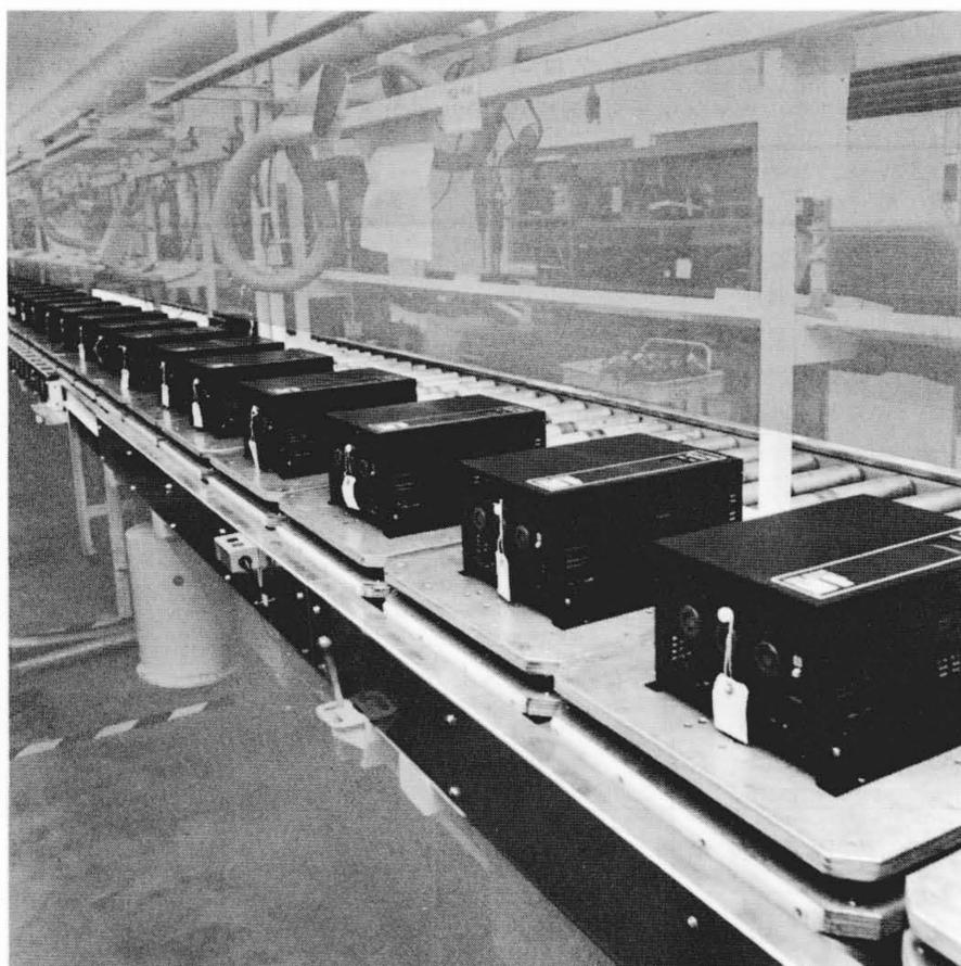
図5 HFC-VWMインバータの外観 量産中の標準形HFC-VWMインバータを示す。
