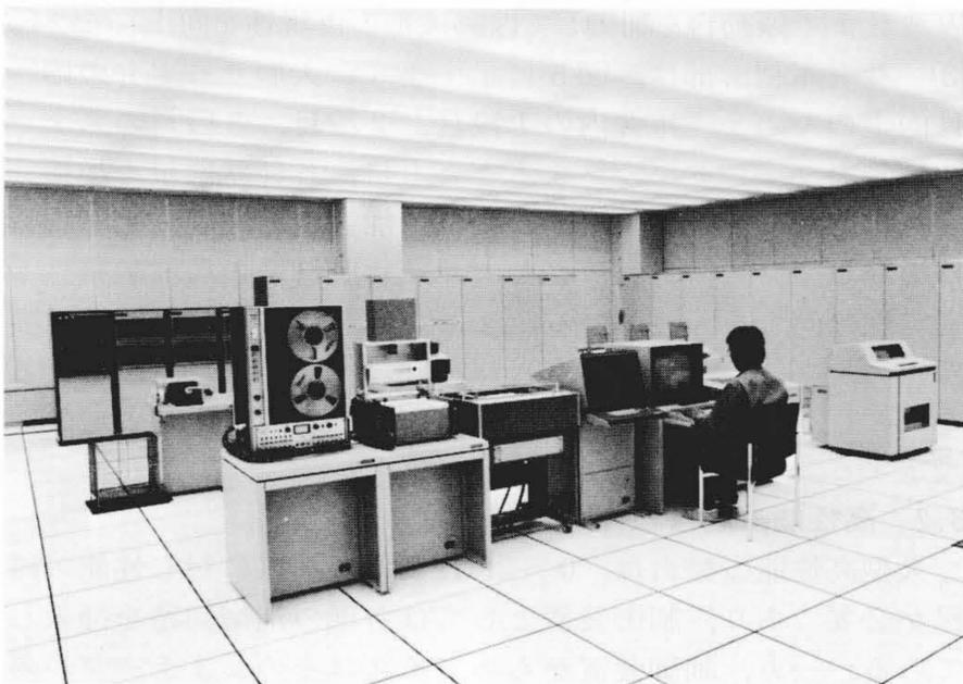
図6 計算制御装置 制御用計算機HIDIC 80を3台とアレイプロセッサを結合した高速演算システムである。
