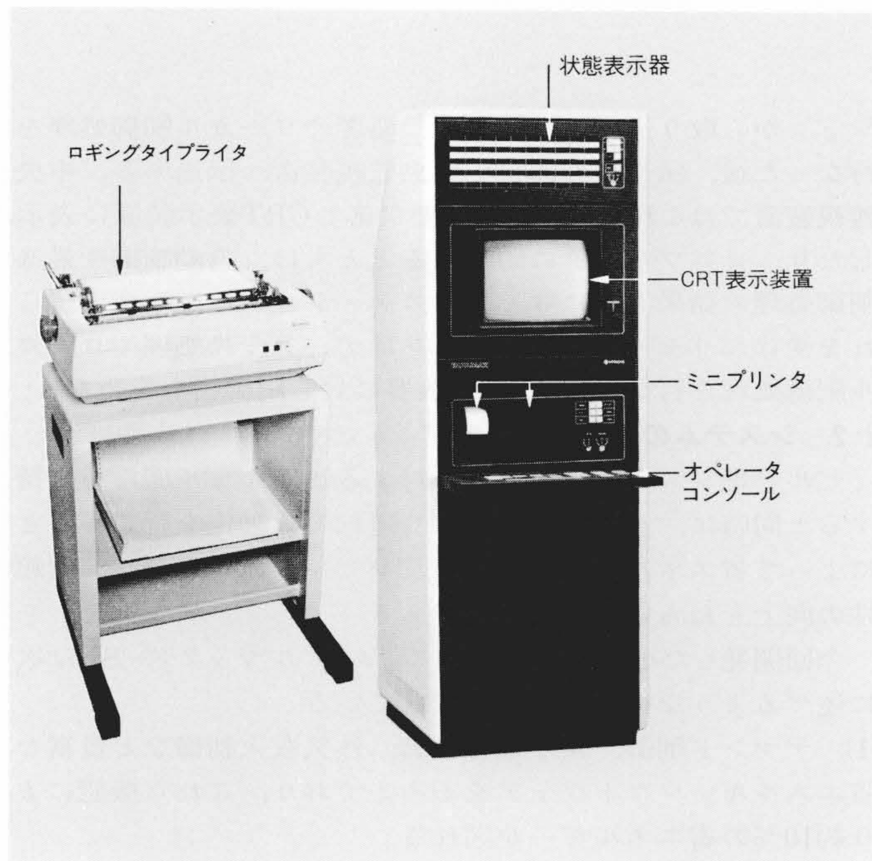
図3 小形ビル管理システム「ビルマックス-S」の中央監視装置 中央監視室に設置し、CRT表示装置やミニプリンタなどを一体化し、更にオペレータコンソールを収納式にしたコンパクトなキュービクルタイプである。
