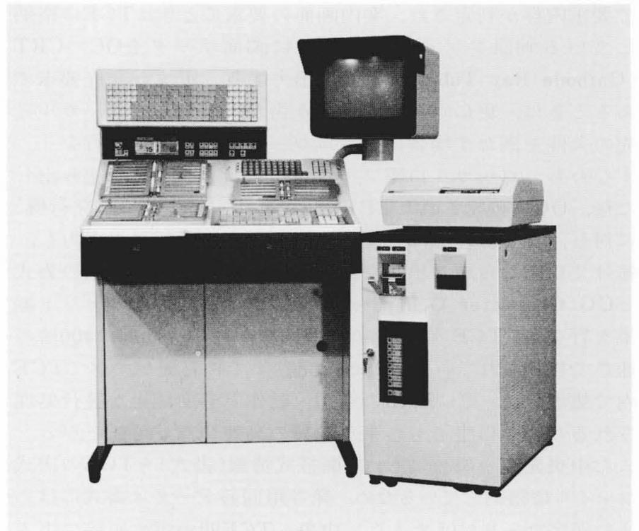
図4 窓口端末装置の外観 CRT画面による入力案内と回答表示が採用され、総合発券端末として多様な券種の発売に対処する。
