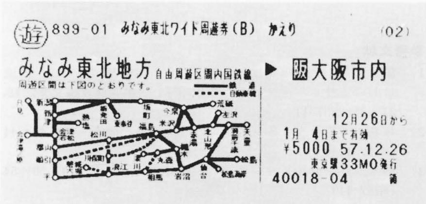
図5 発行券面の印字例 各券面に最適な大きさの漢字を使った、見やすい券面となっている。
