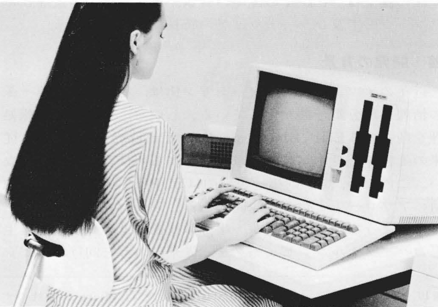
図3 PT-1パーソナルターミナル ディスプレイ、フロッピーディスク及び制御部を卓上形で構成している。このほか、ディスプレイ、ディスク、フロッピーディスク及び制御部を一体化したモデルがある。
