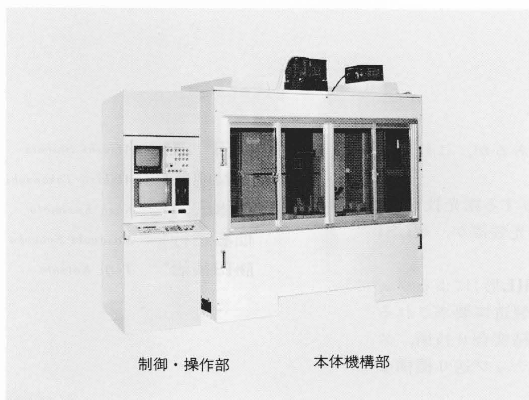
図3 RA-101HL形 本体機構部(右)は、恒温クリーンチャンバ内に設置されている。
