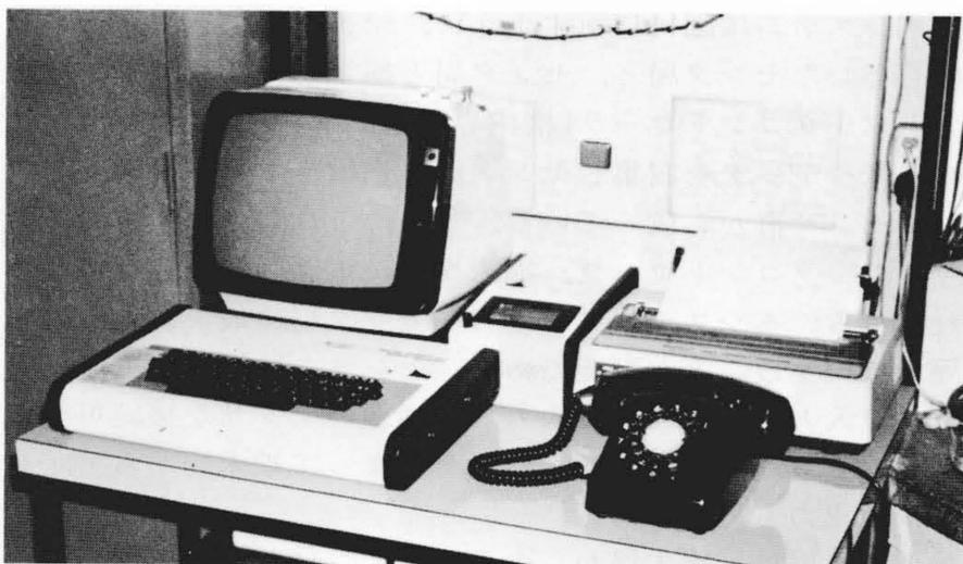
図12 センタ局の構成例 マイクロコンピュータ、ディスプレイ、プリンタ、デジタルカセット及びモデム、回線インタフェースから成っている。
