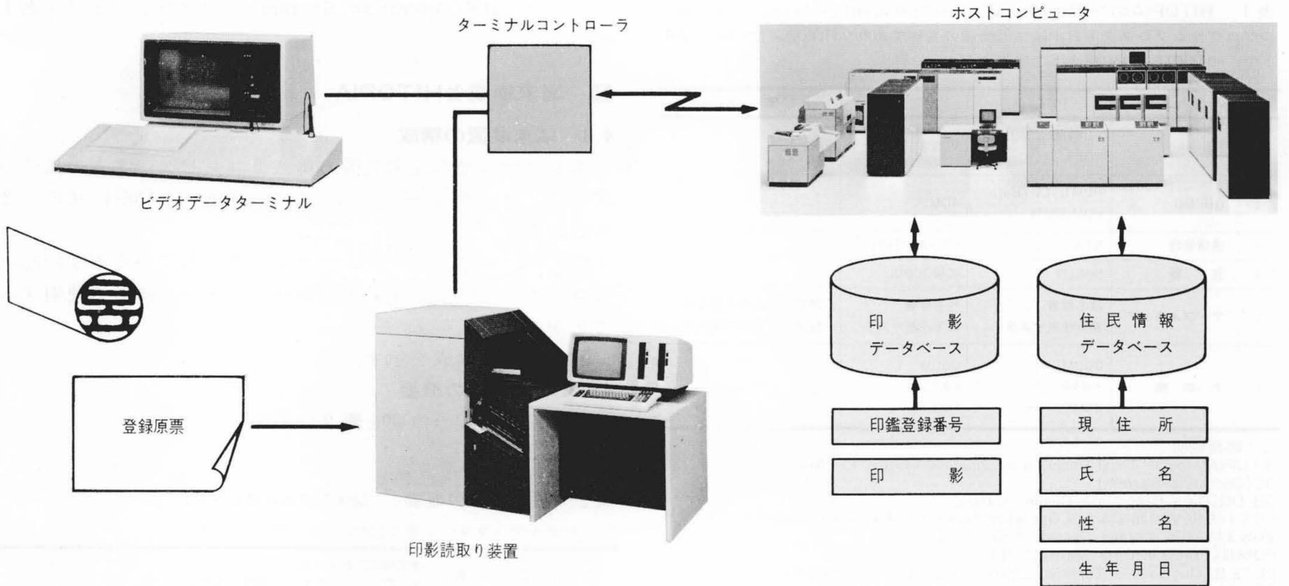
図4 印鑑登録証明システム(印鑑登録) 登録原票を印影読取り装置に入力すれば、印影の登録が完了する。
