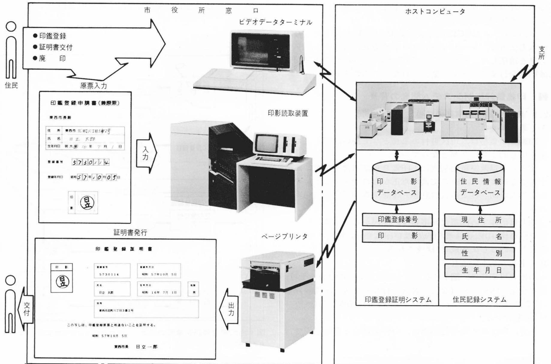
図2 印鑑登録証明システム コンピュータ処理による印鑑登録及び証明書発行の基本的な流れを示す。
