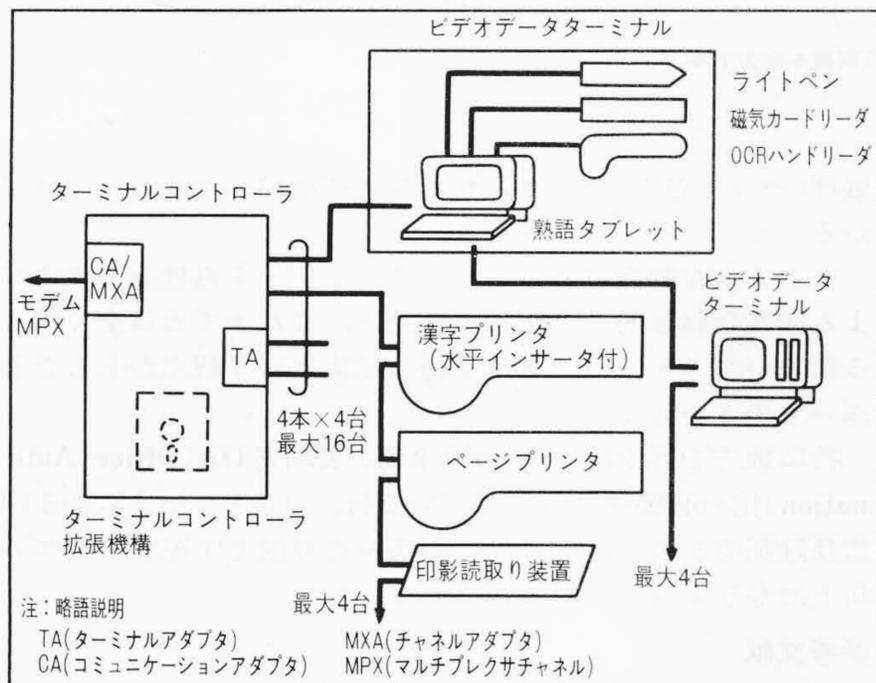
図3 端末構成 印鑑登録証明システムを実現するための端末ハードウェア構成を示す。
