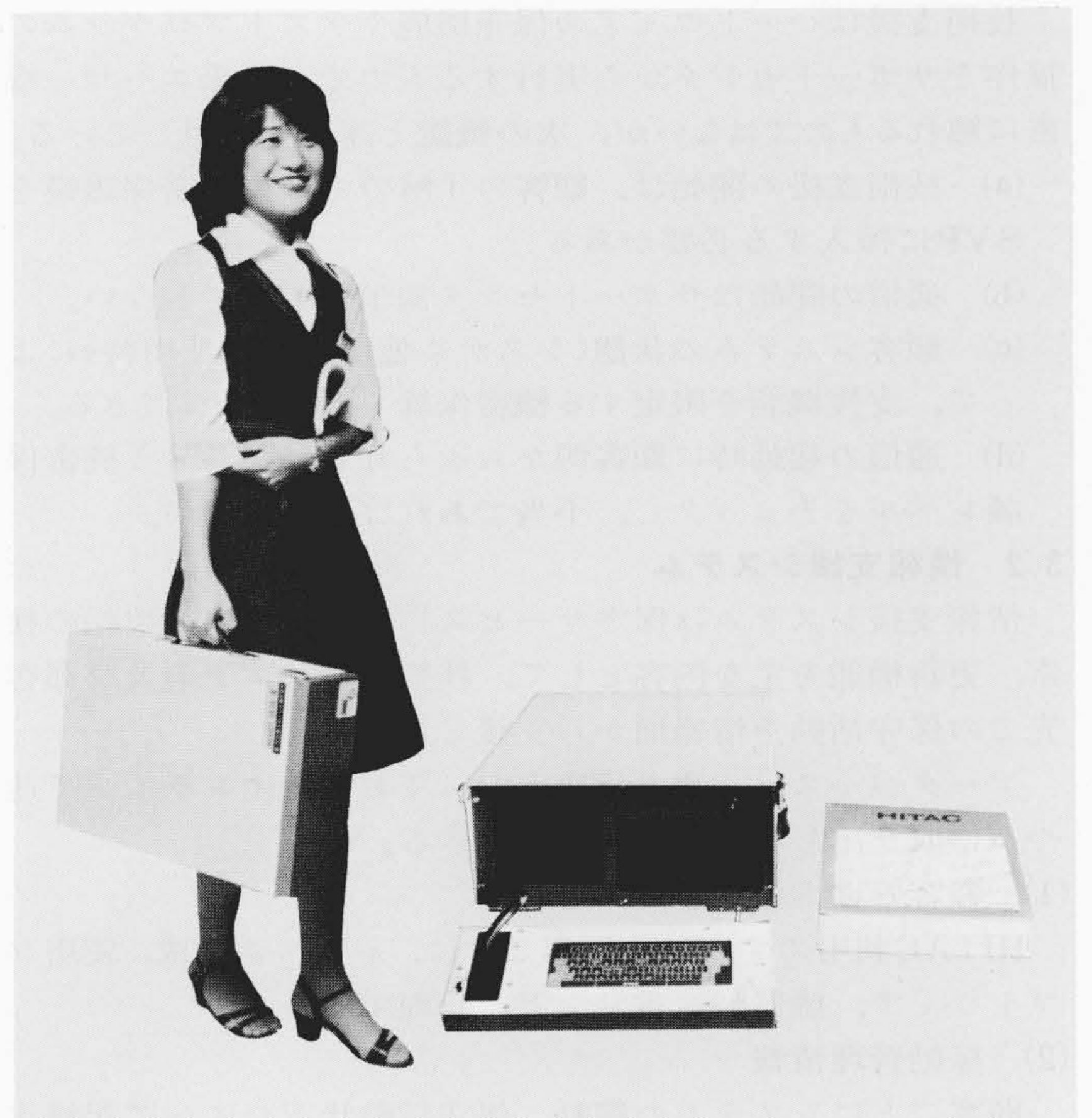
図6 可搬形SVPの外観 小形ディスプレイ、フロッピーディスクを内蔵し、かつ重量を9 kgに抑えた。
