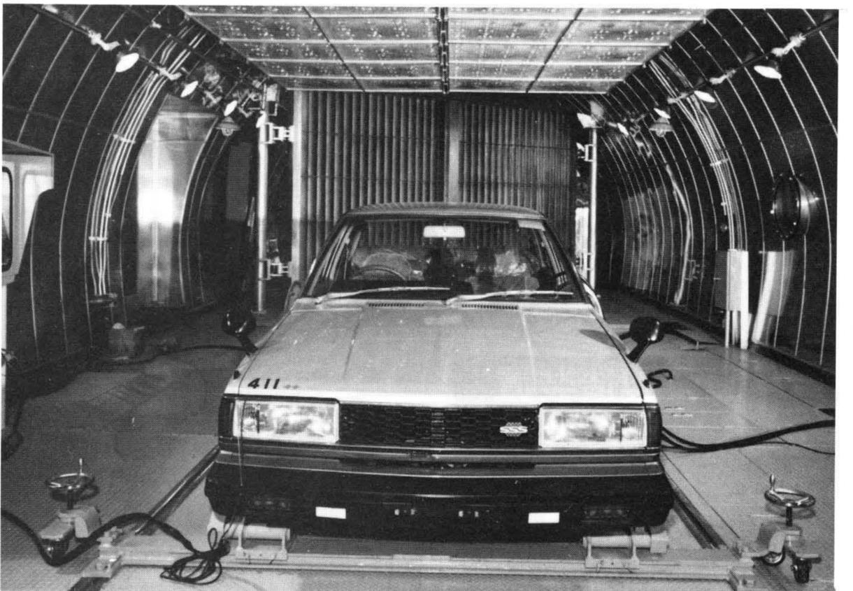
図37 自動車環境試験装置の内部
