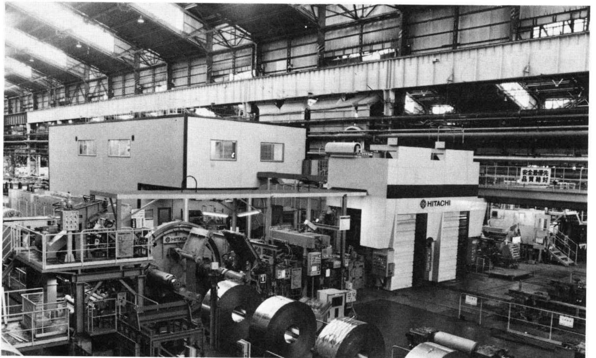
図2 連続式高性能調質圧延設備の全容
