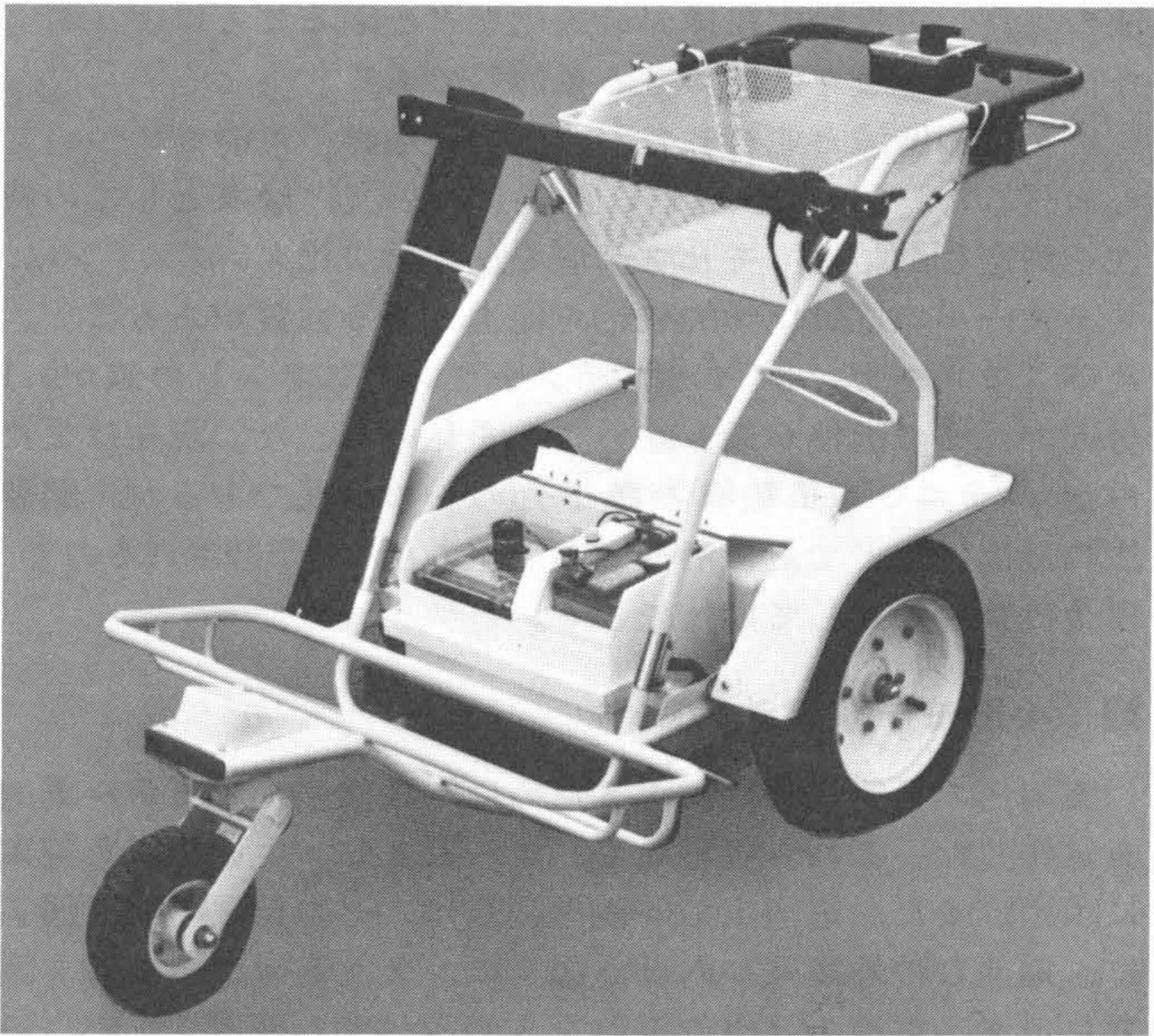
図10 メタノール燃料電池を電源とするゴルフカート 中央部下段に電源を置いている。向かって左側がメタノール燃料電池で、右側が鉛蓄電池である。
