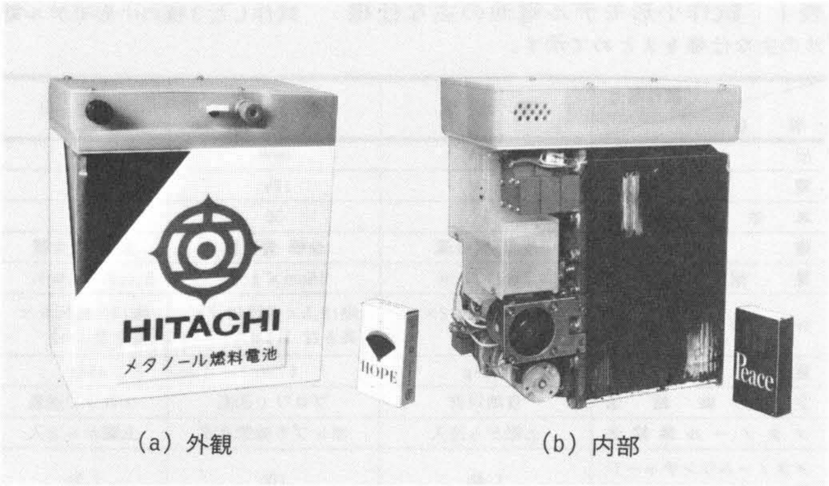
図8 電池IIの外観及び内部 電池IIの外観と内部を示す。自動車用12V鉛蓄電池と同一寸法にしてあり、重量は約半である。内部写真の左側に見えるのが600ml入りメタノールタンクである。
