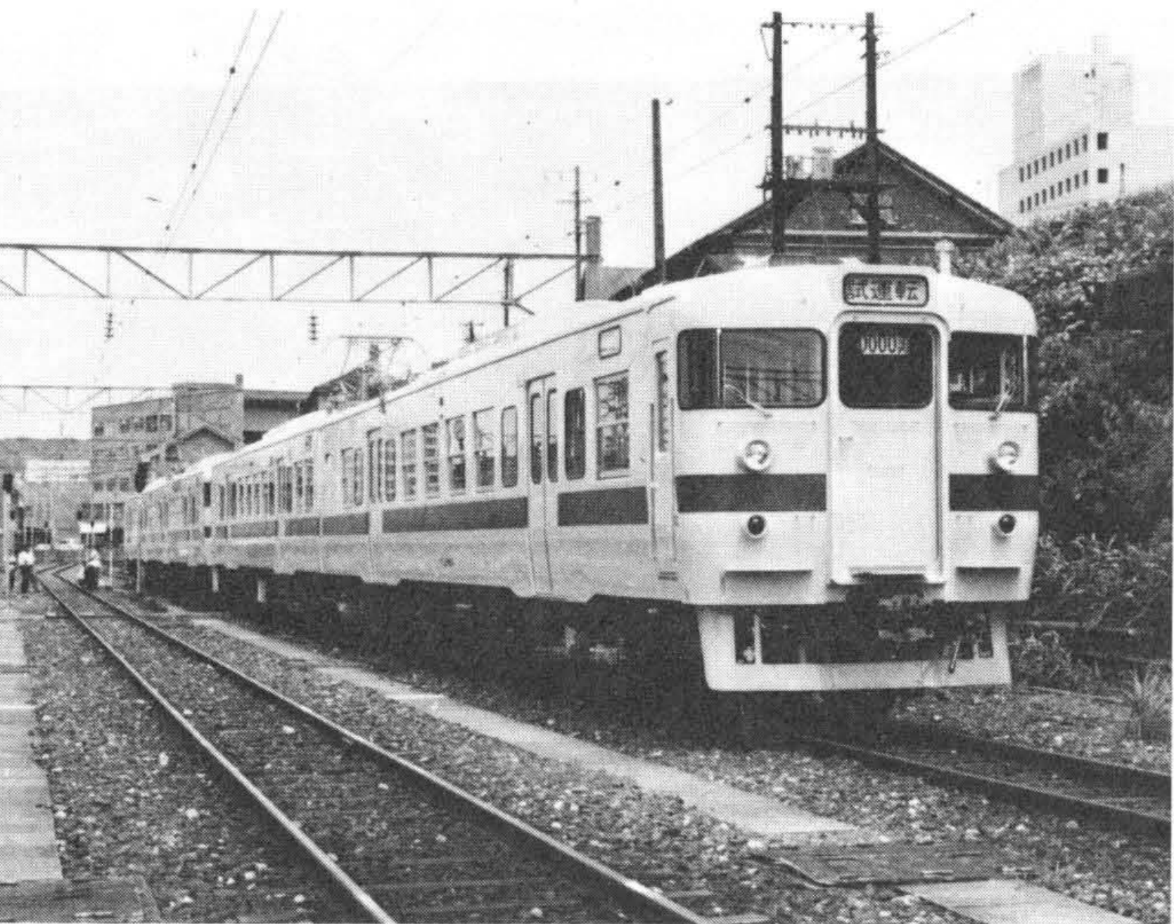
図1 713系近郊形交流電車 鹿児島本線に投入された我が国で最初の交流回生ブレーキ付電車を示す。
