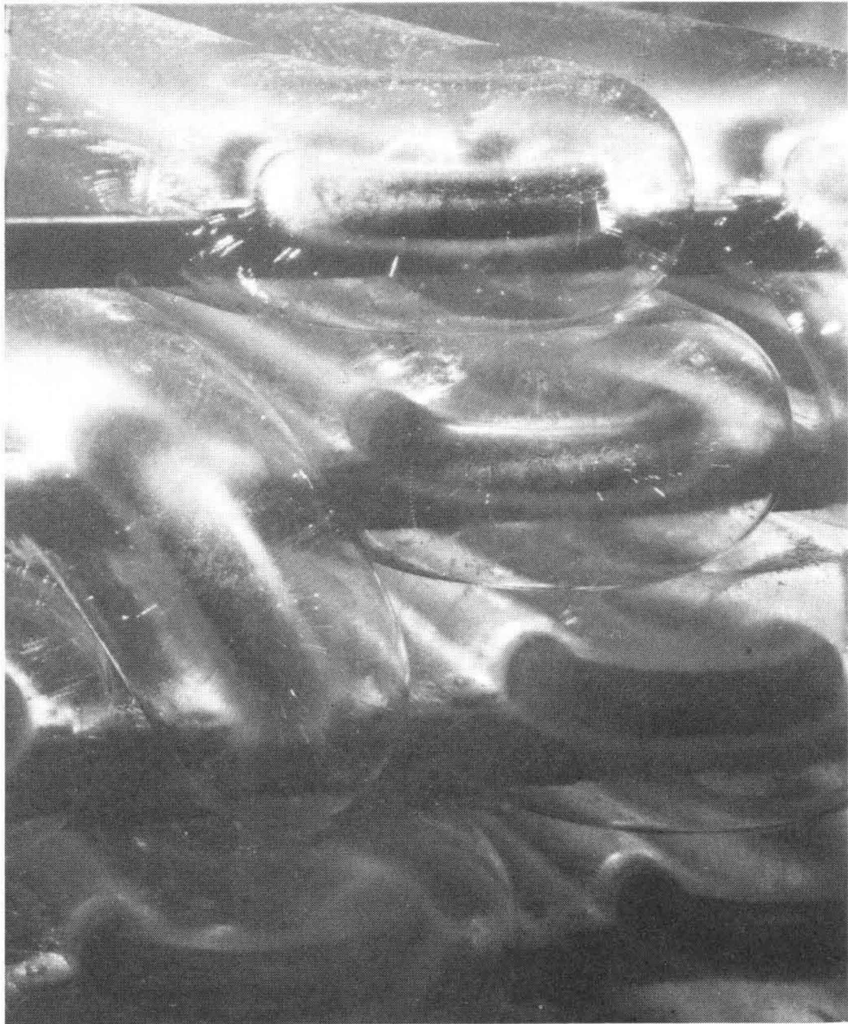
図 7 氷蓄熱槽の着氷状態 3 m 3 氷蓄熱槽での着氷状態を示す。
