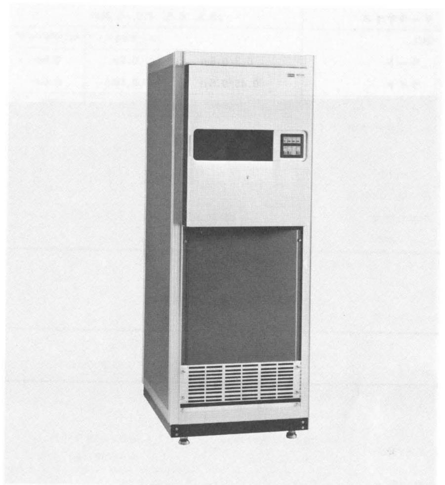
図2 ラックマウントタイプ磁気テープ装置 19inの標準ラックにマウントでき、磁気テープコントローラを内蔵している。
