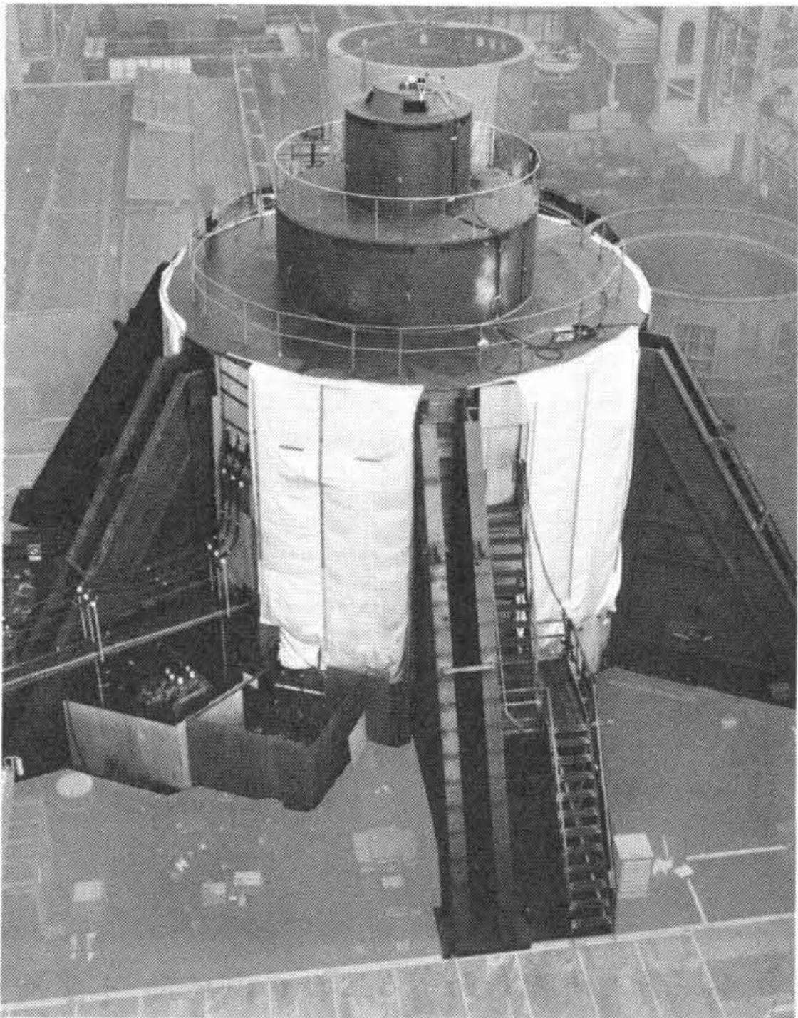
図3 工場試験中の電動発電機の外観 電動発電機は工場で回転試験を行ない、電気特性、機械特性を測定し、良好であることを確認した。
