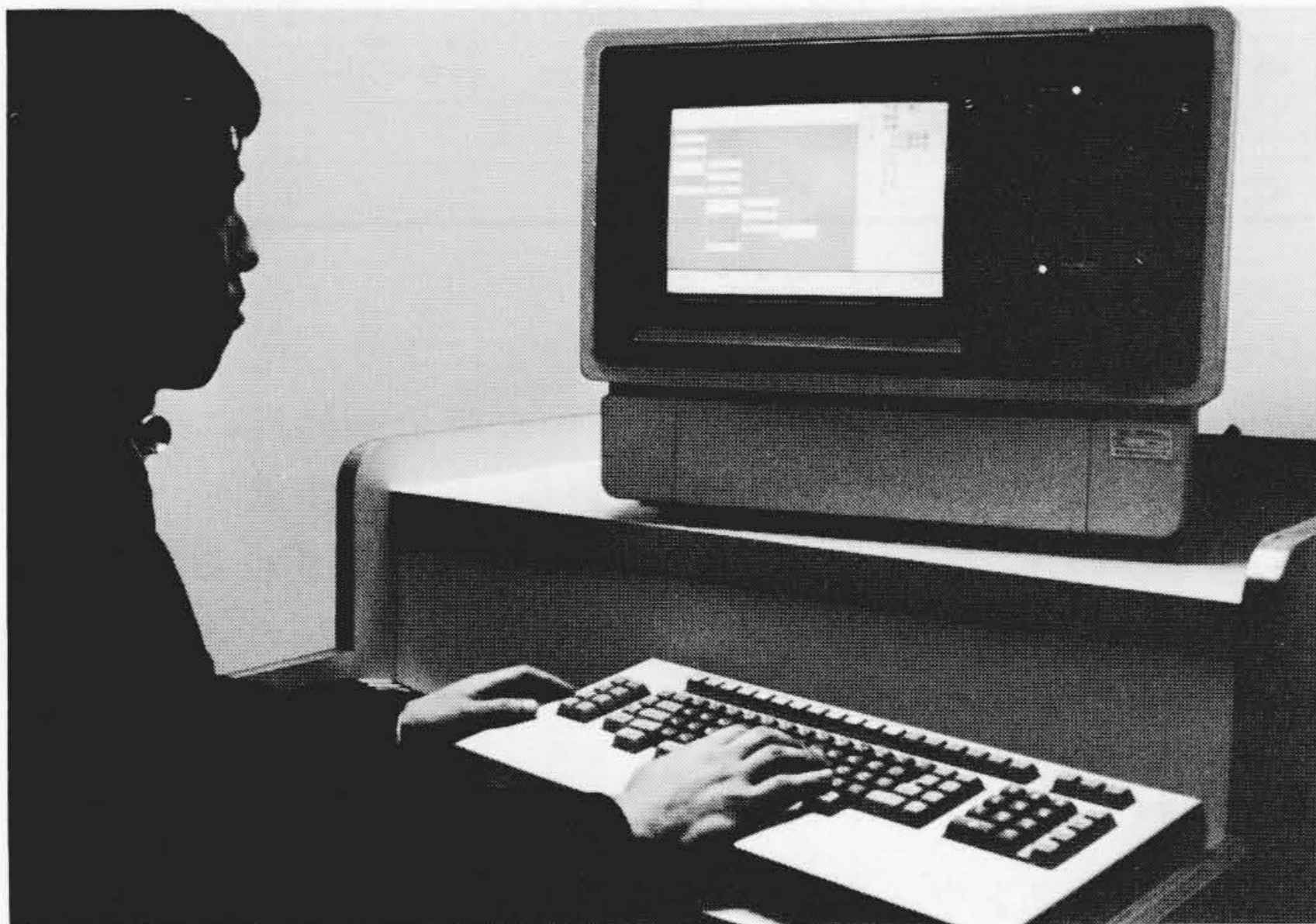
図4 SEWBを用いたソフトウェア開発 SEWBのヒューマンフレンドリーなマンマシンインタフェースを通して、プログラム自動生成システムSDL/PADを利用している光景を示す。開発者は、図の要素を積み木細工のように組み合わせさえすれば、プログラムコードは自動的に支援システムが作成してくれる。
