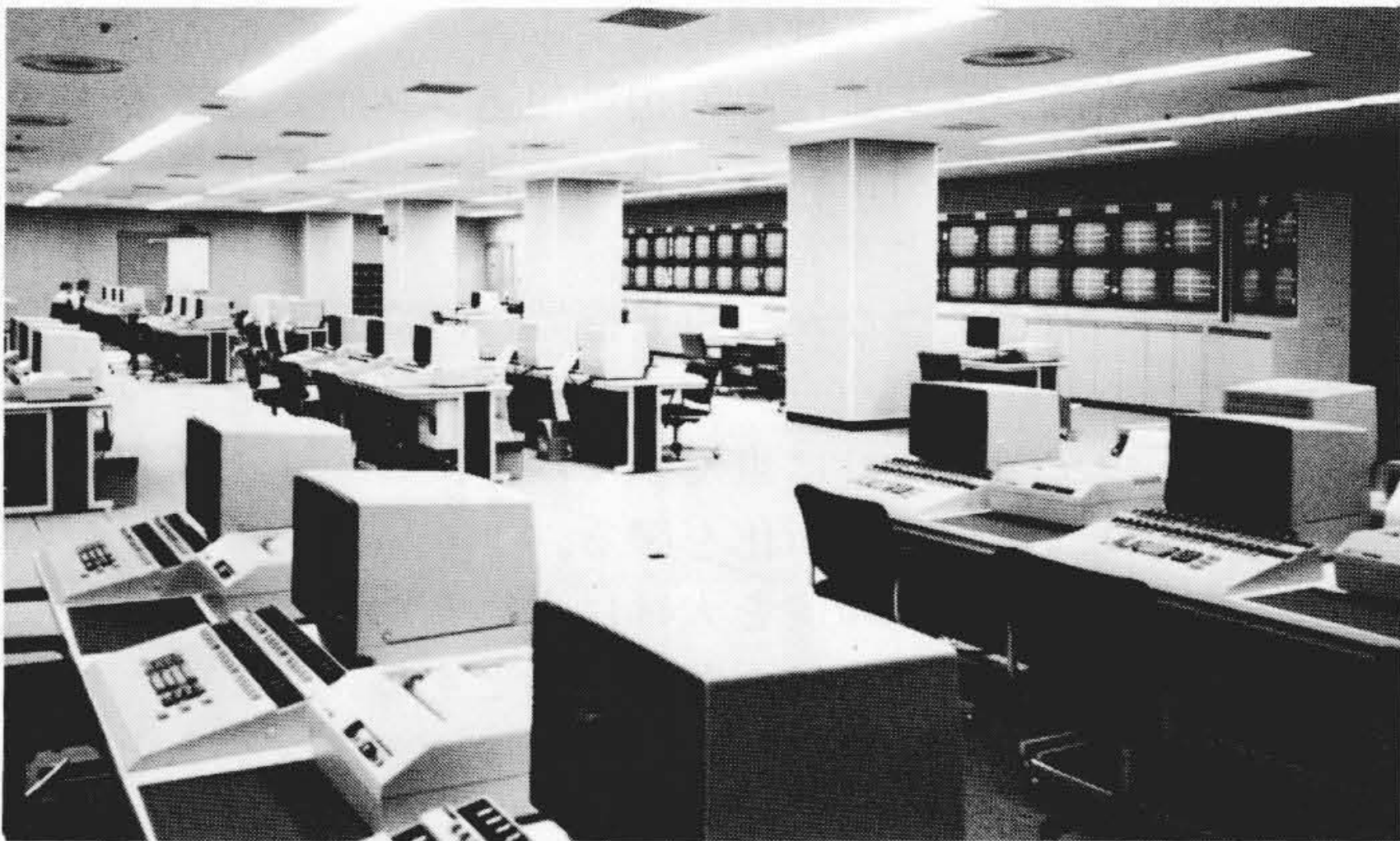
図2 新システム売買室 システム銘柄の売買取引を指示する才取会員端末、売買取引を監視する売買管理端末が設置されている新システム売買室を示す。
