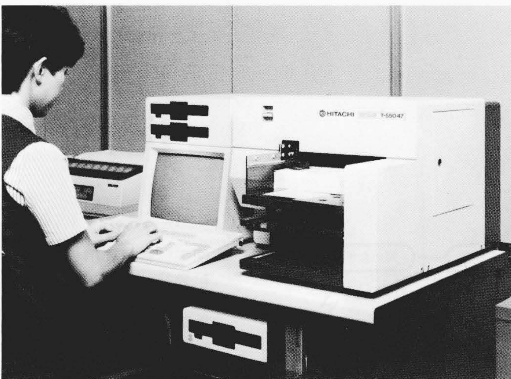
図4 T-550/47分散形小形OCR 本OCRを全国の支社、営業所に設置することにより、新契約データの直接入力が可能となった。
