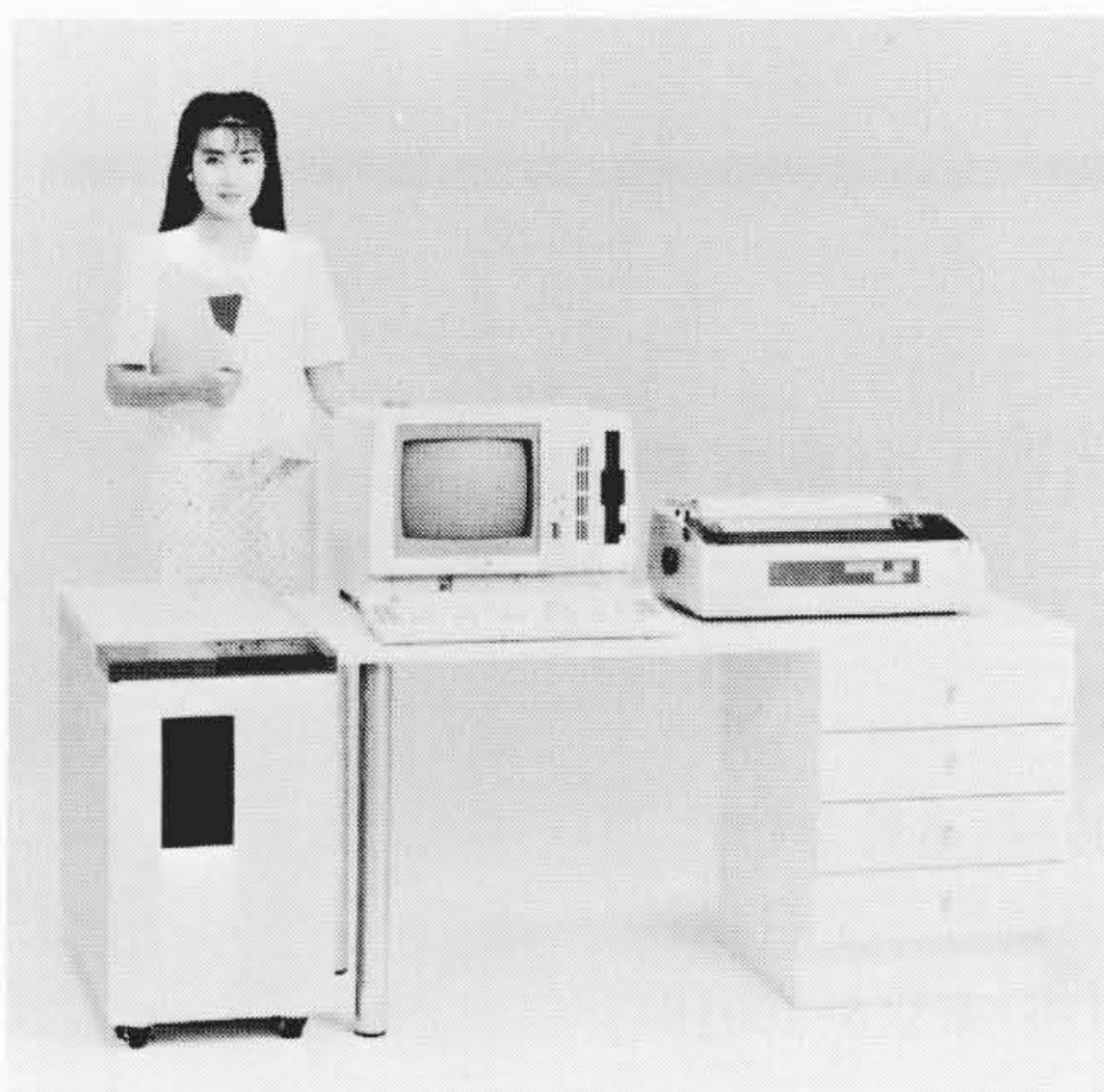
図1 VI-50のシステム構成例(左からVI-50、PT-I/EX、プリンタ)
