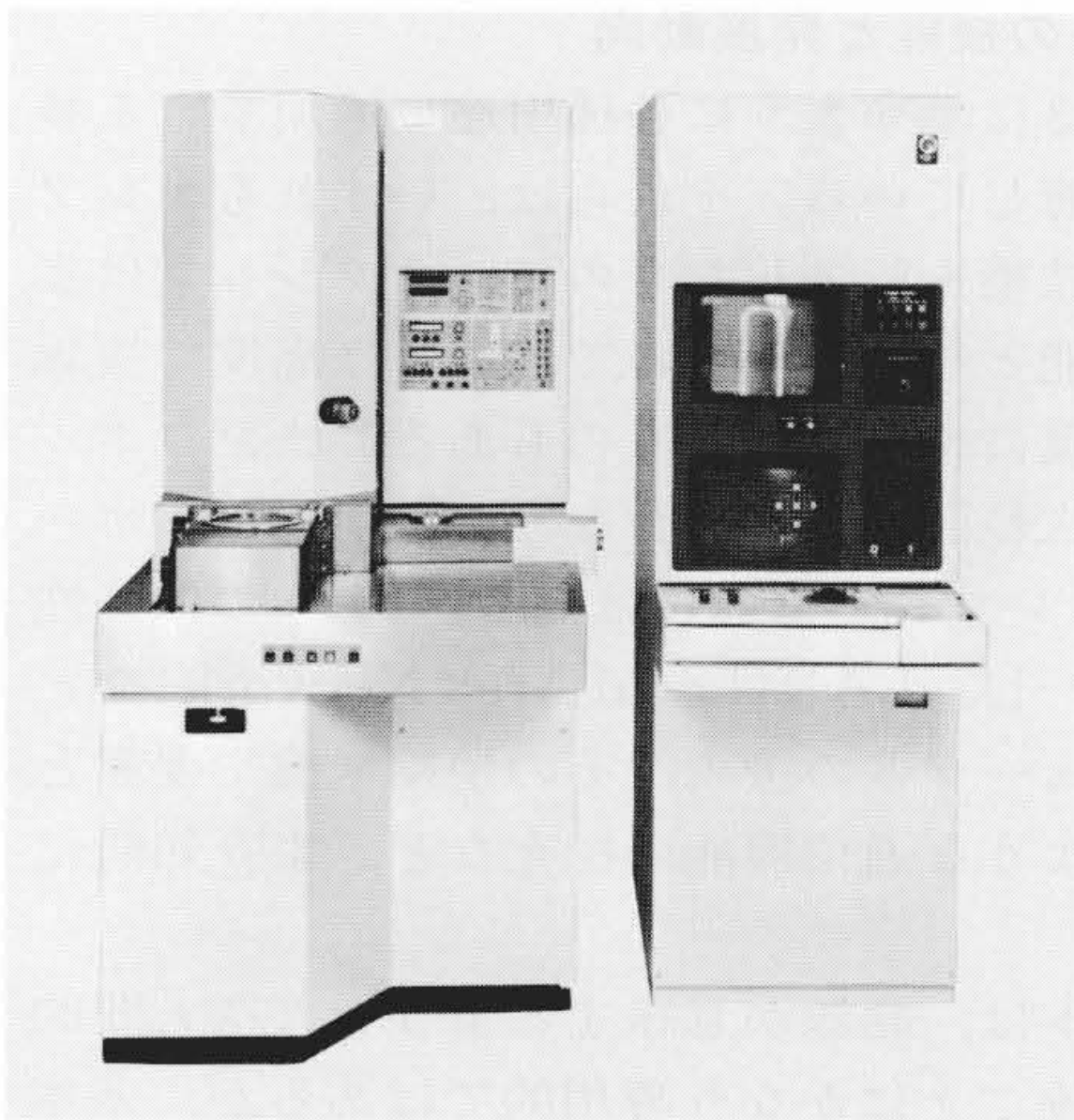
図5 日立FEB測長装置(S-6000) 走査電子顕微鏡を、IC回路の測定に適用した計測装置である。
