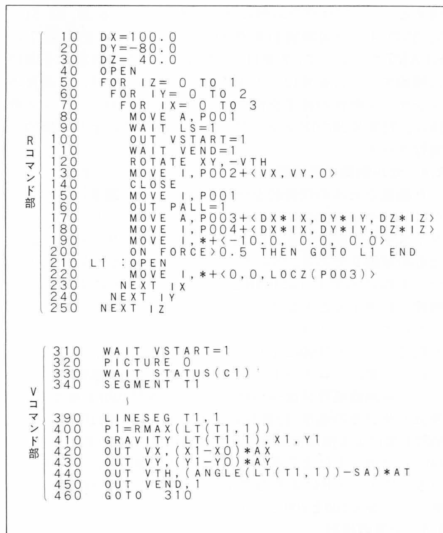
図9 FA-BASICのプログラム例 パレタイズ作業でのロボット動作と画像処理を記述した部分を示す。
