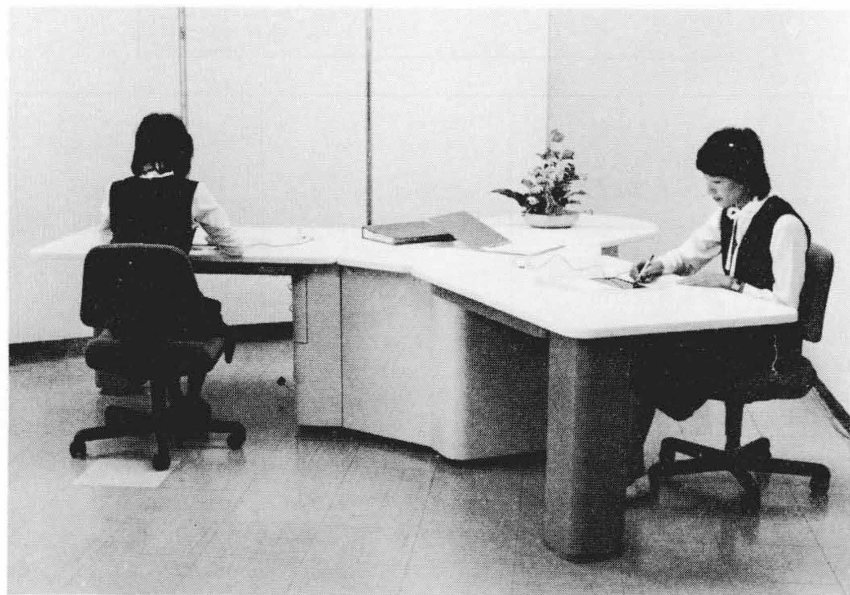
図2 ワークステーションの外観 手書き入力ができる入力一体化平面ディスプレイは机の上に設置され、女性が持っているペンで入力できる。机は楽しく仕事ができるように120度レイアウトや丸みをもったデザインが施されている。またCRTを設置する場合は、中央部に置くスペースも確保されている。
