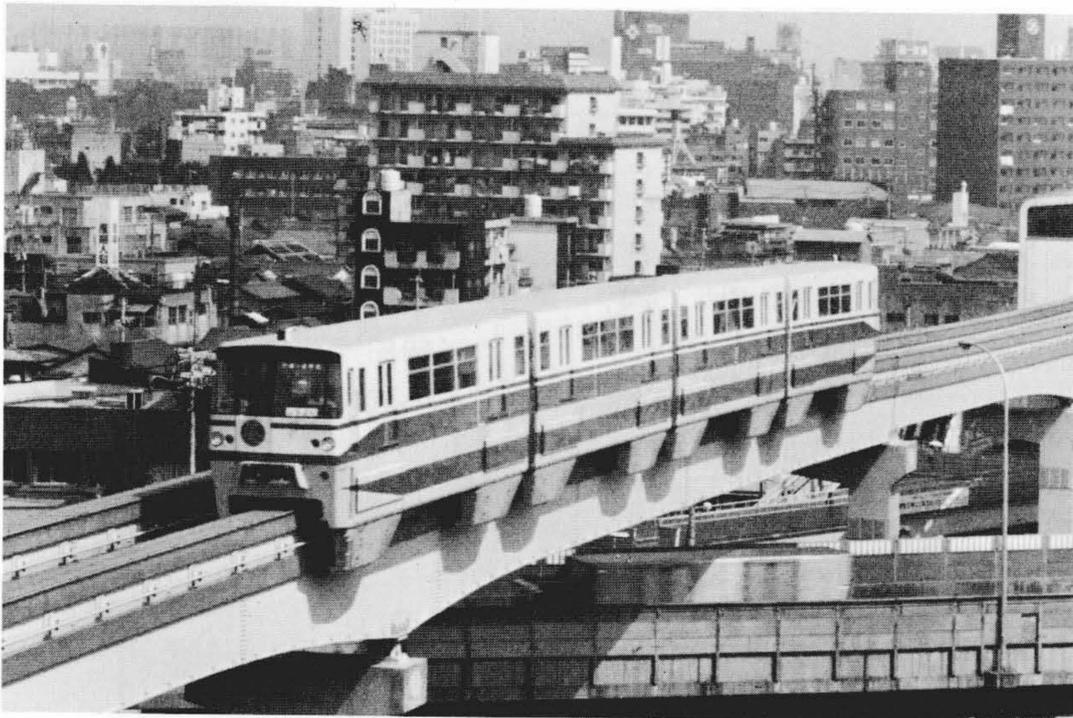
図1 北九州市の都市モノレール小倉線 4両固定編成とし、1編成当たり1,078人の輸送量がある。
