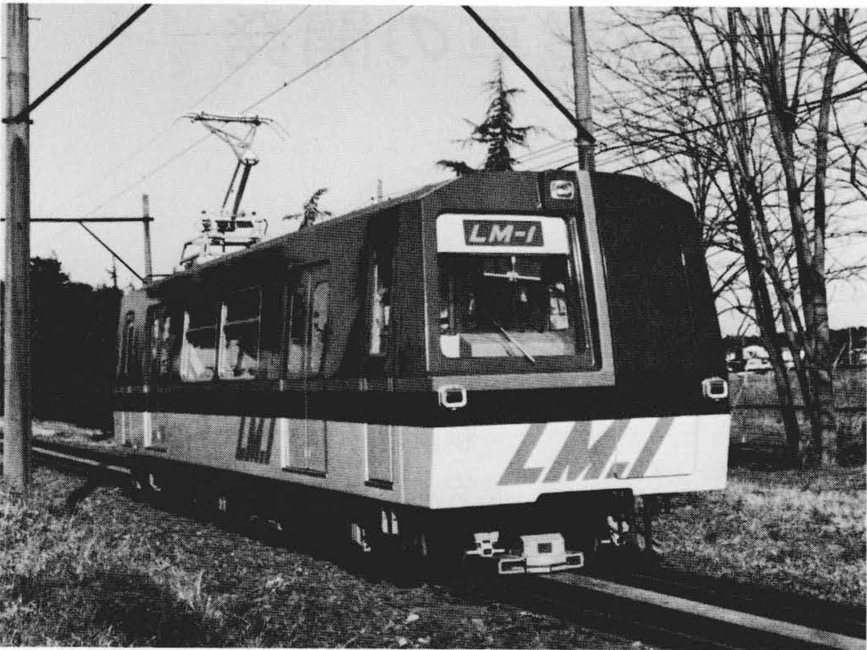
図1 リニアモーターカー 我が国で最初に完成した鉄車輪支持によるリニアモーターカーで、日立製作所の工場内試験線で走行試験中の実況を示す。
