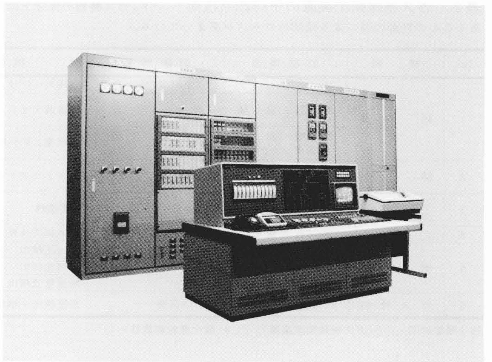
図5 静止形継電器を採用したリレー盤と“HISMAC” “HISMAC”は電子化された受変電監視制御装置で、静止形継電器と組み合わせてリレーの自動点検が可能であり、また小形でスペースをとらないため、従来形の監視制御盤が増設困難なとき従来盤の数分の一のスペースで更新及び増設ができる(ディスク幅1,800mm)。
