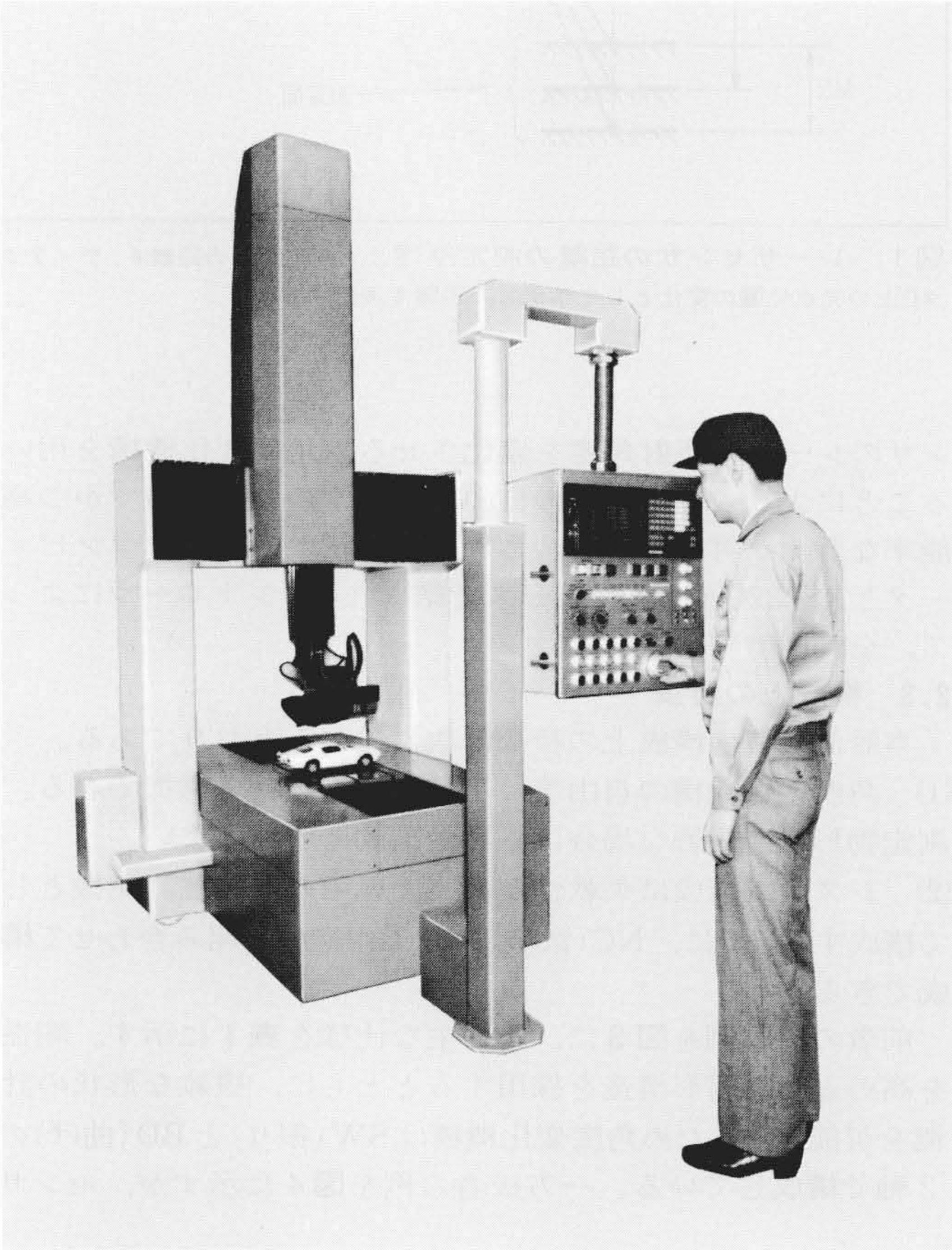
図3 専用の非接触計測機として構成した例 剛性を高めるため、門形構造を採用している。
