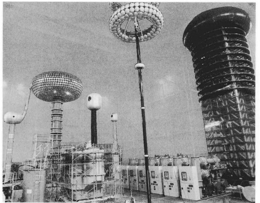
図5 絶縁試験中のハイブリッド絶縁275kV試作器 ハイブリッド絶縁技術を適用し、275kV巻線巻通し構造、各種タップ巻線構造を試作して、絶縁破壊試験を実施した。
