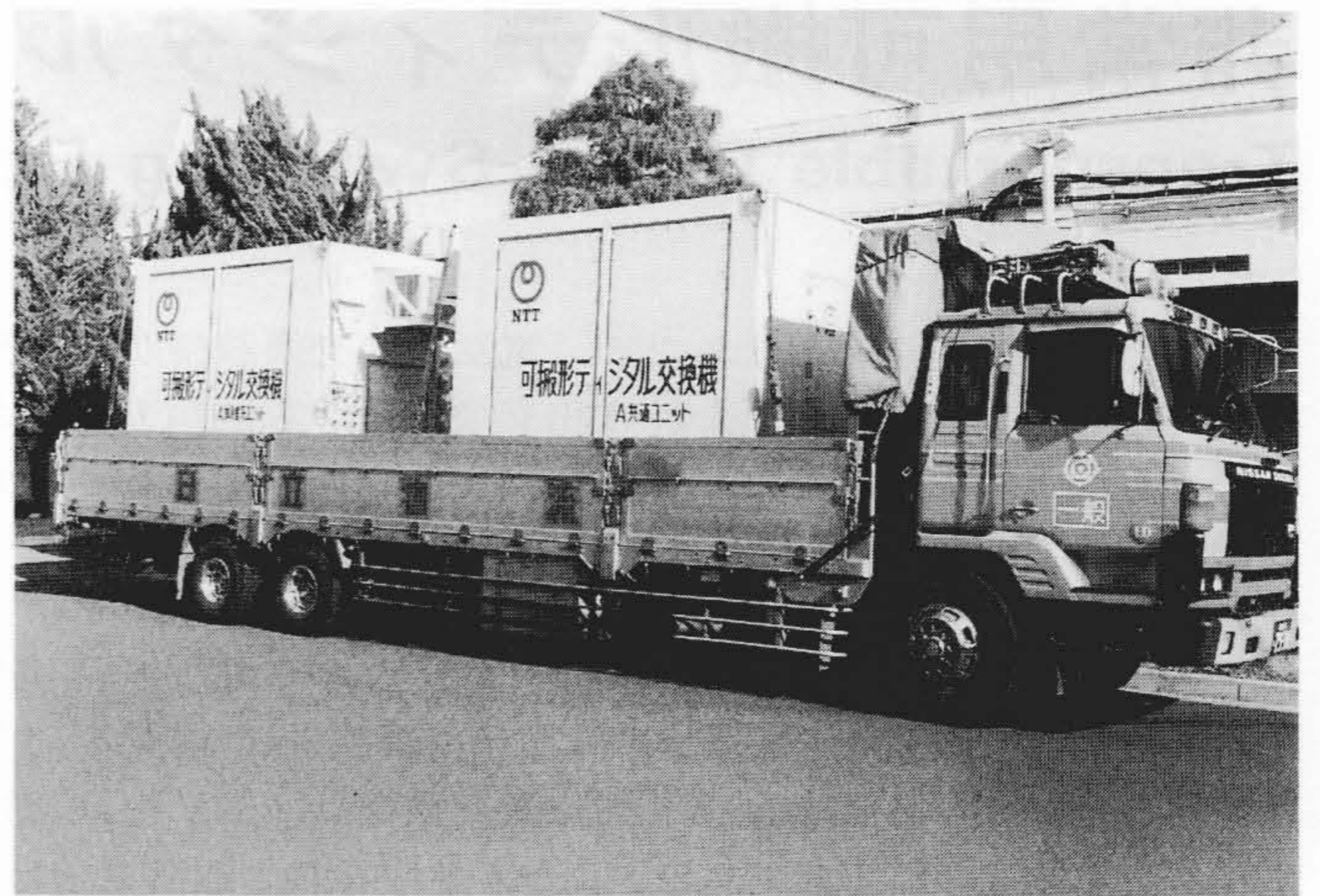
図2 非常用可搬形デジタル交換装置(共通装置箱ほか)外観図 11tトラックに二箱搭載した状態を示す。
