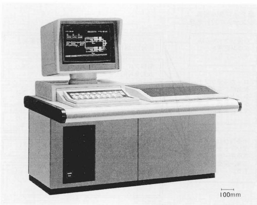
図4 オペレータコンソールデスク POCをデスク内に収納し、CRT、キーボード、タイプライタをコンパクトにまとめた。
