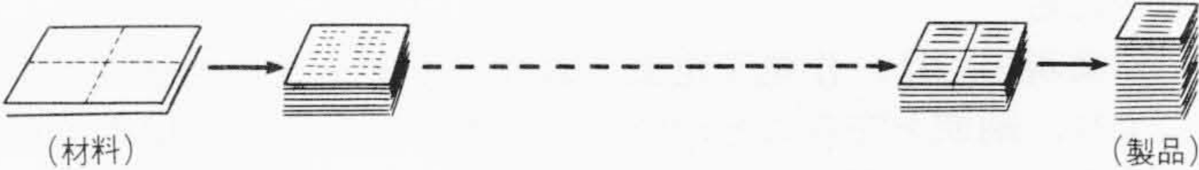
図1 製品の製作工程 プリント基板の製造工程の一例を示す。材料を加工サイズに切断する工程から、製品サイズにカットし、最終チェック工程を経て完成となる。
