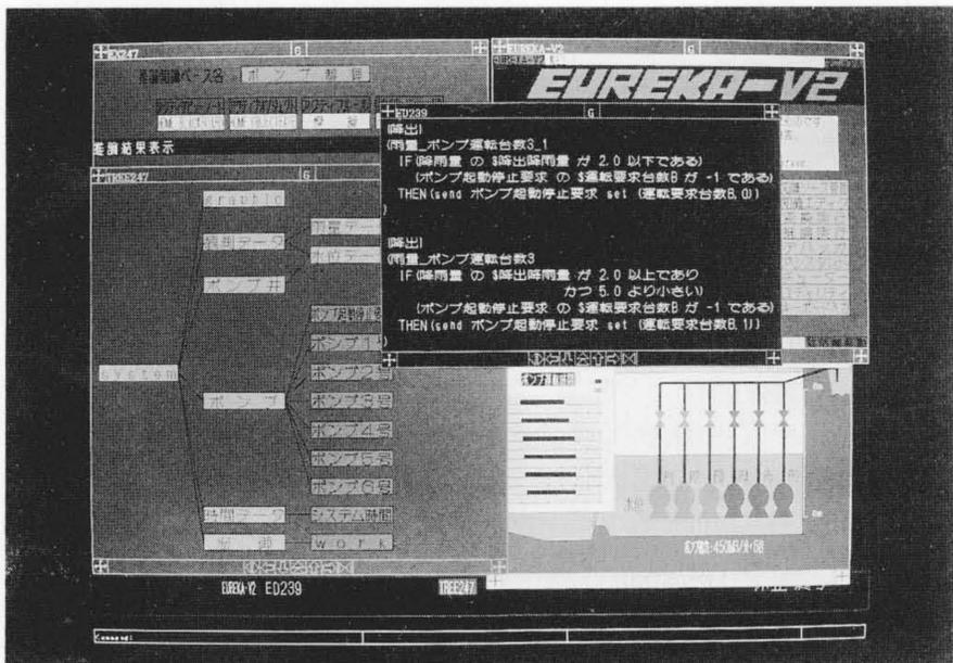
図7 EUREKAの専門家インタフェースの画面例 デバッガを通じて推論にどんなルールやフレームが使われているか知ることができる。ブラウザによってフレームの階層的関係も知ることができる。
