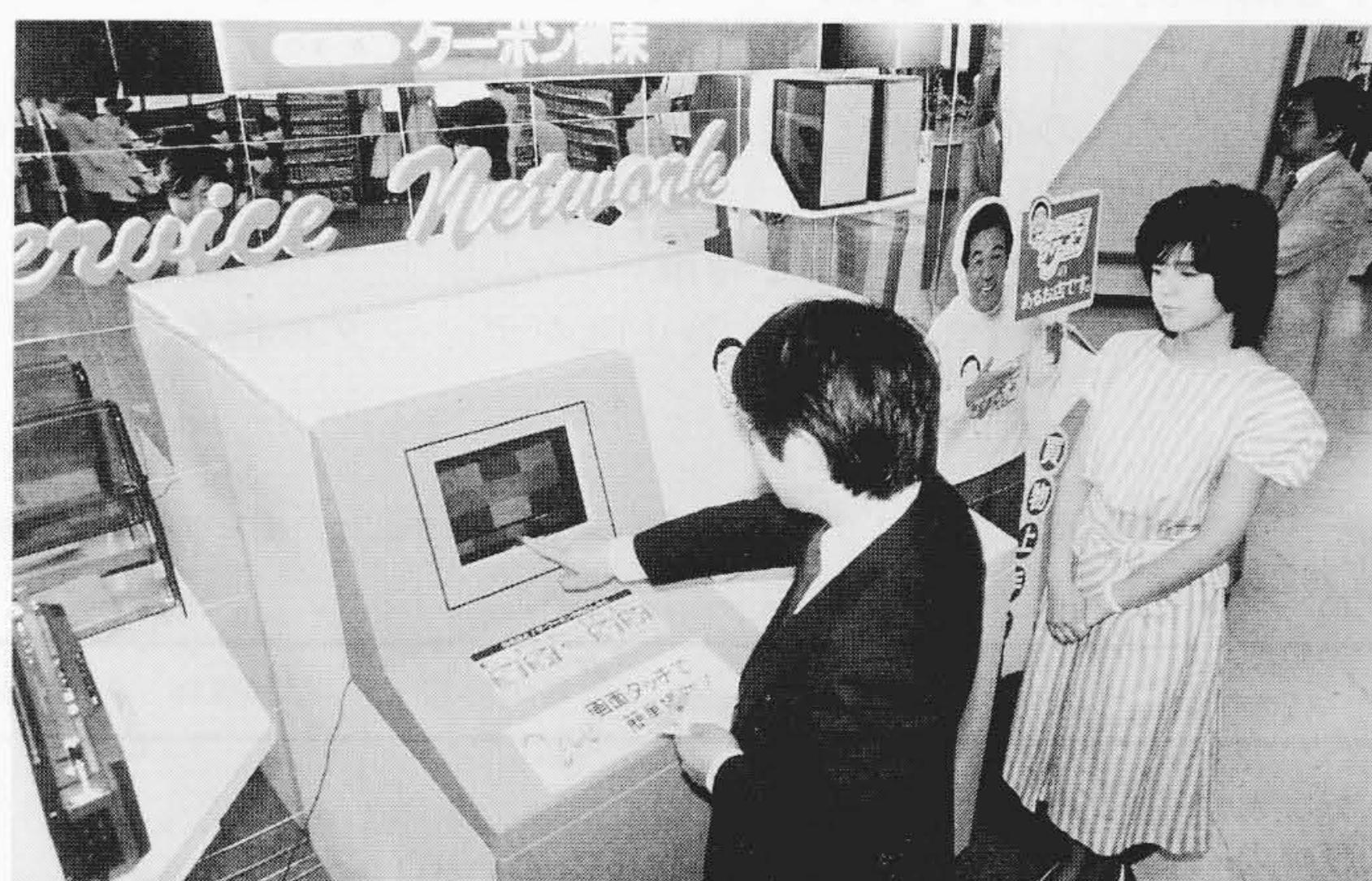
図2 クーポン端末 パーソナル ターミナルとタッチパネル、オートカットプリンタをベースとしたクーポン発券サービスシステム「なるほど! ザ・クーポン」である(協力:フジサンケイグループ)。
