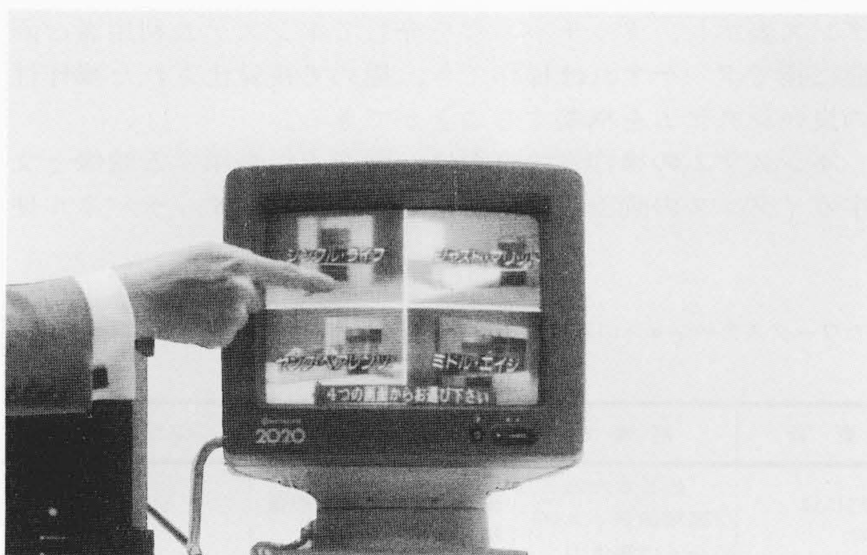
図1 ビジュアル インフォメーション ターミナルの外観 パーソナルワークステーション2020をベースに、光ビデオディスク、タッチパネルによるエレクトロニック カタログ ショッピング システムである(協力:株式会社東急百貨店)。
