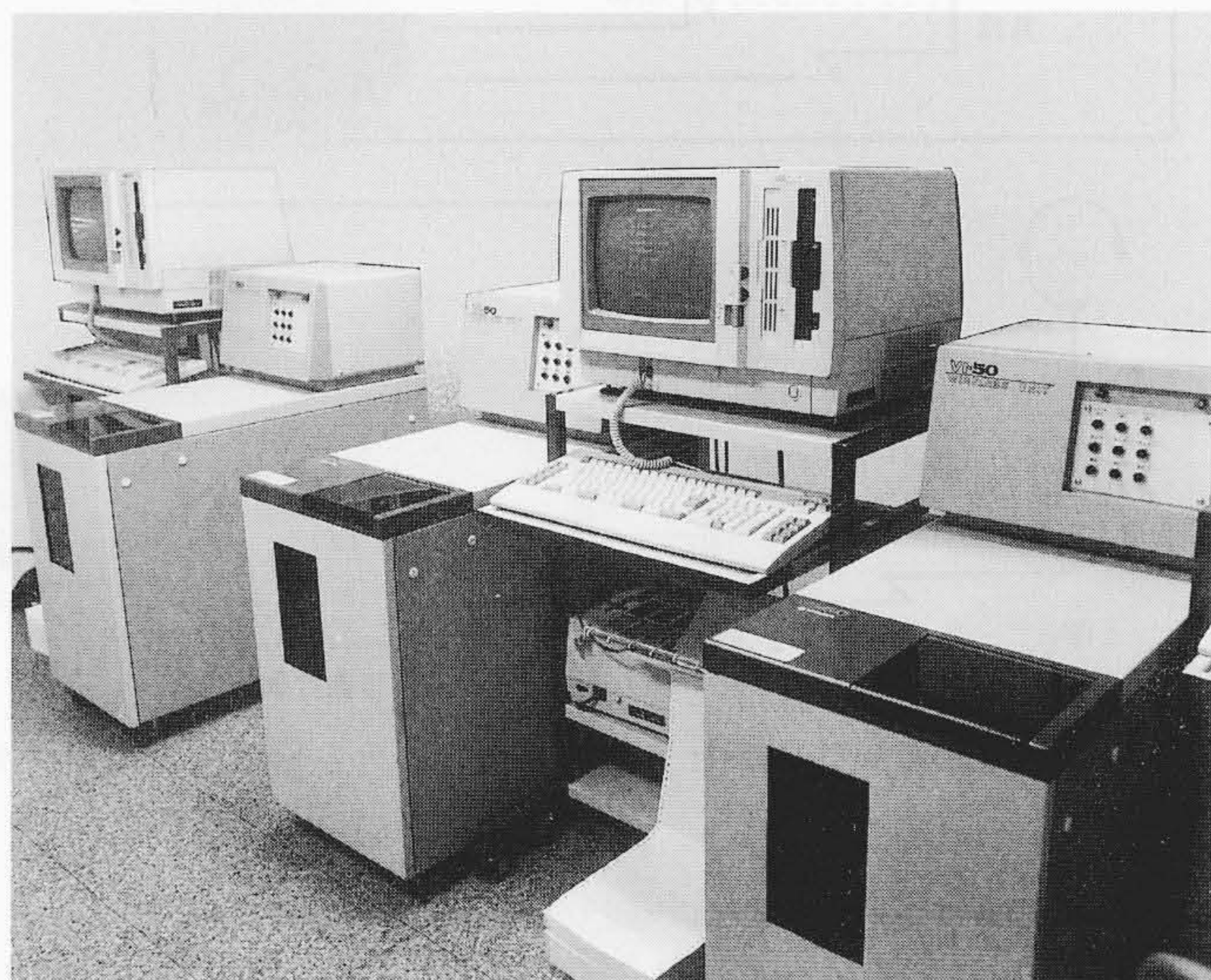
図4 東京淀橋青果株式会社荷受業務音声入出力システム機器 音声入出力装置(VI-50)と日立パーソナルコンピュータ(PT-1/EX)を設置してあることを示す。
