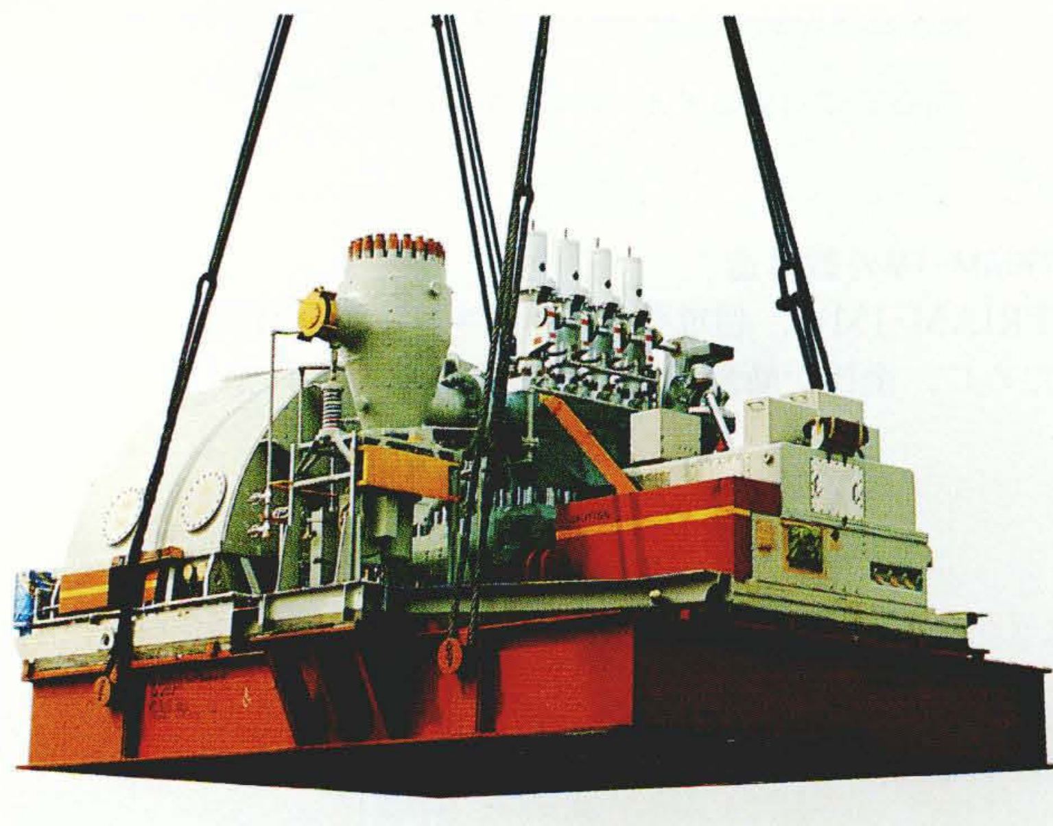
一体輸送を行うコ・ジェネレーション、コンバインドプラント用蒸気タービン
