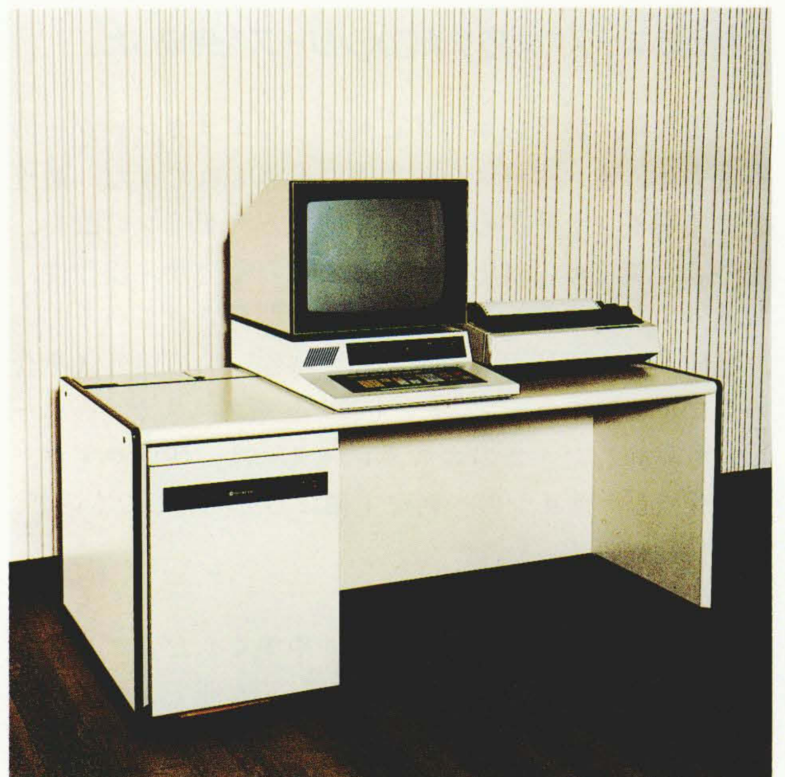
「フレキシブルで話せる」ビル管理システム“BUILMAX-M”の中央監視装置
