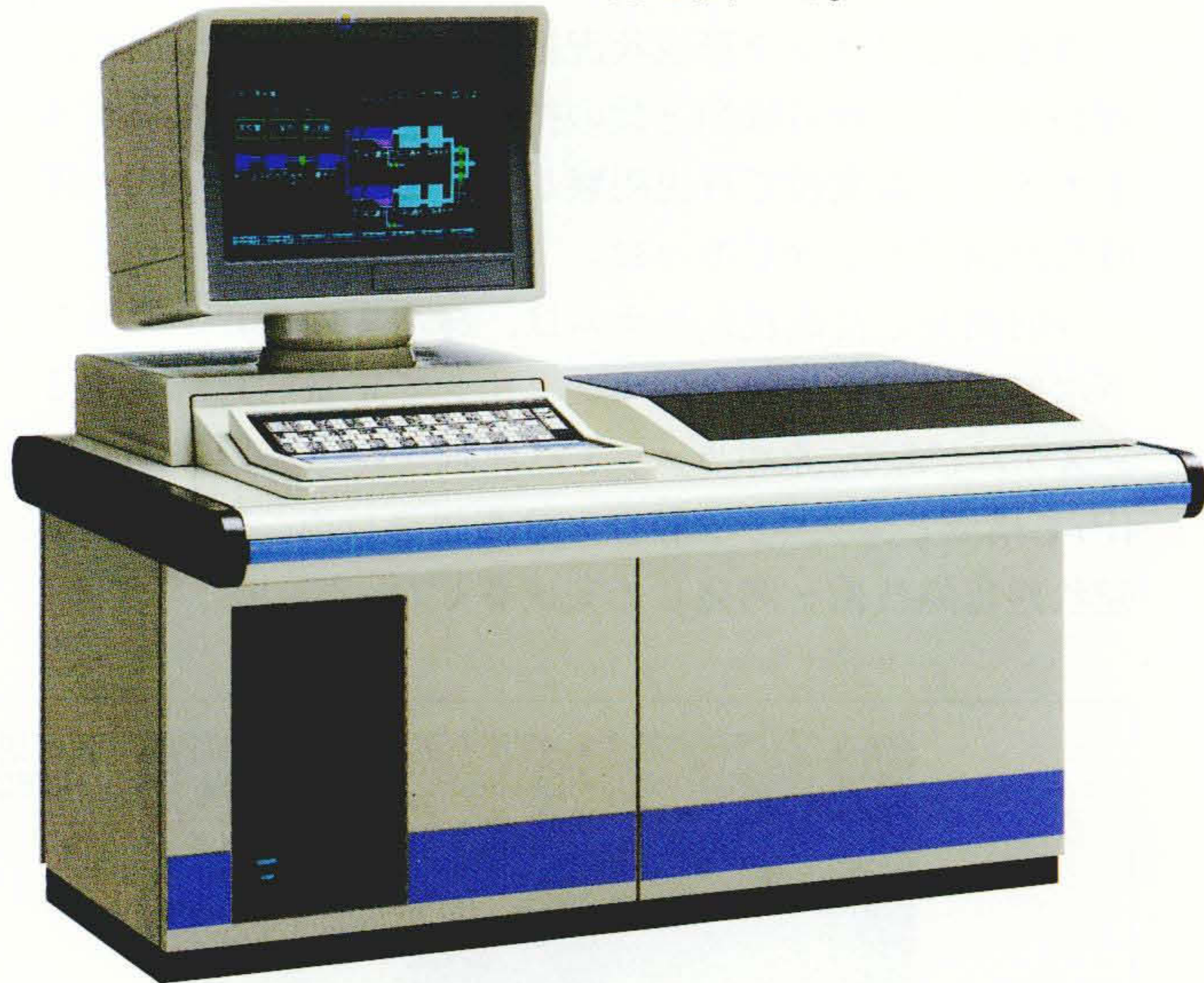
上下水道監視制御システム“AQUAMAX-1000” オペレータコンソールディスク
