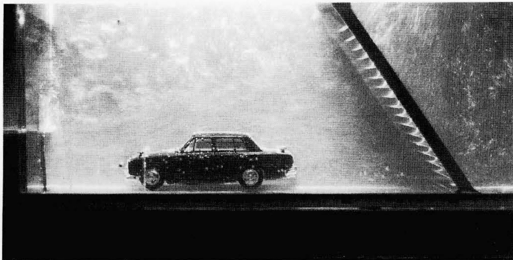
図2 モデルによる水槽可視化実験 気体が車体を包む流れの状態を、立体的に把握した。
