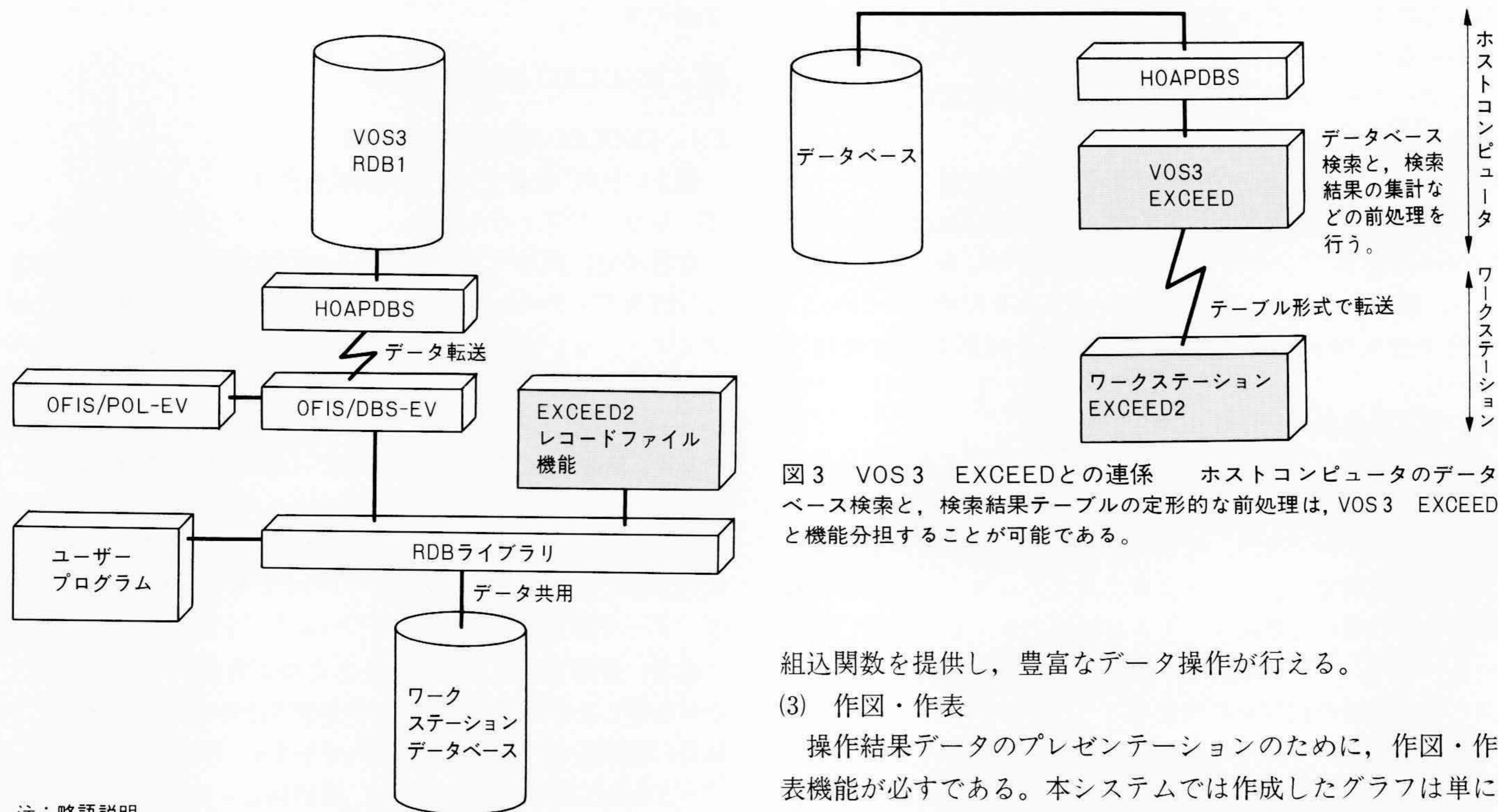
図3 VOS 3 EXCEEDとの連係 ホストコンピュータのデータベース検索と、検索結果テーブルの定形的な前処理は、VOS 3 EXCEEDと機能分担することが可能である。
