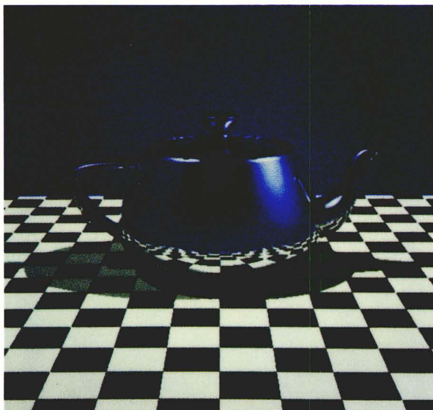
図10 ティーポット レイトレーシングによる自由曲面の表示例を示す。
