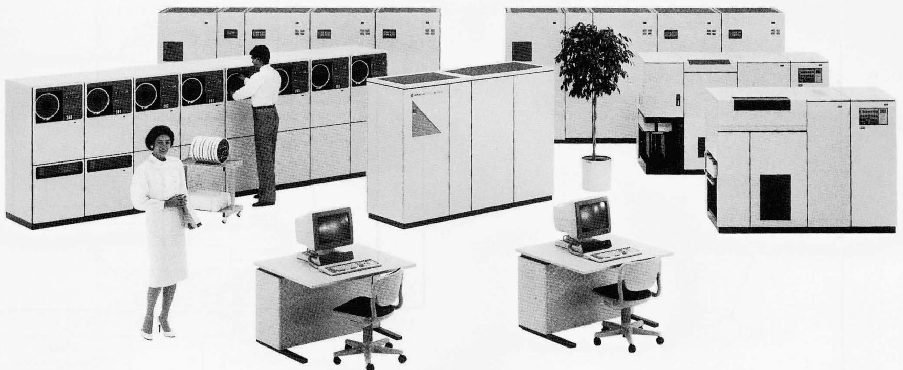
図1 M-660Kシステム外観 M-66Xは、主記憶容量を最大256Mバイト、チャネル台数を最大32まで拡張できる。
