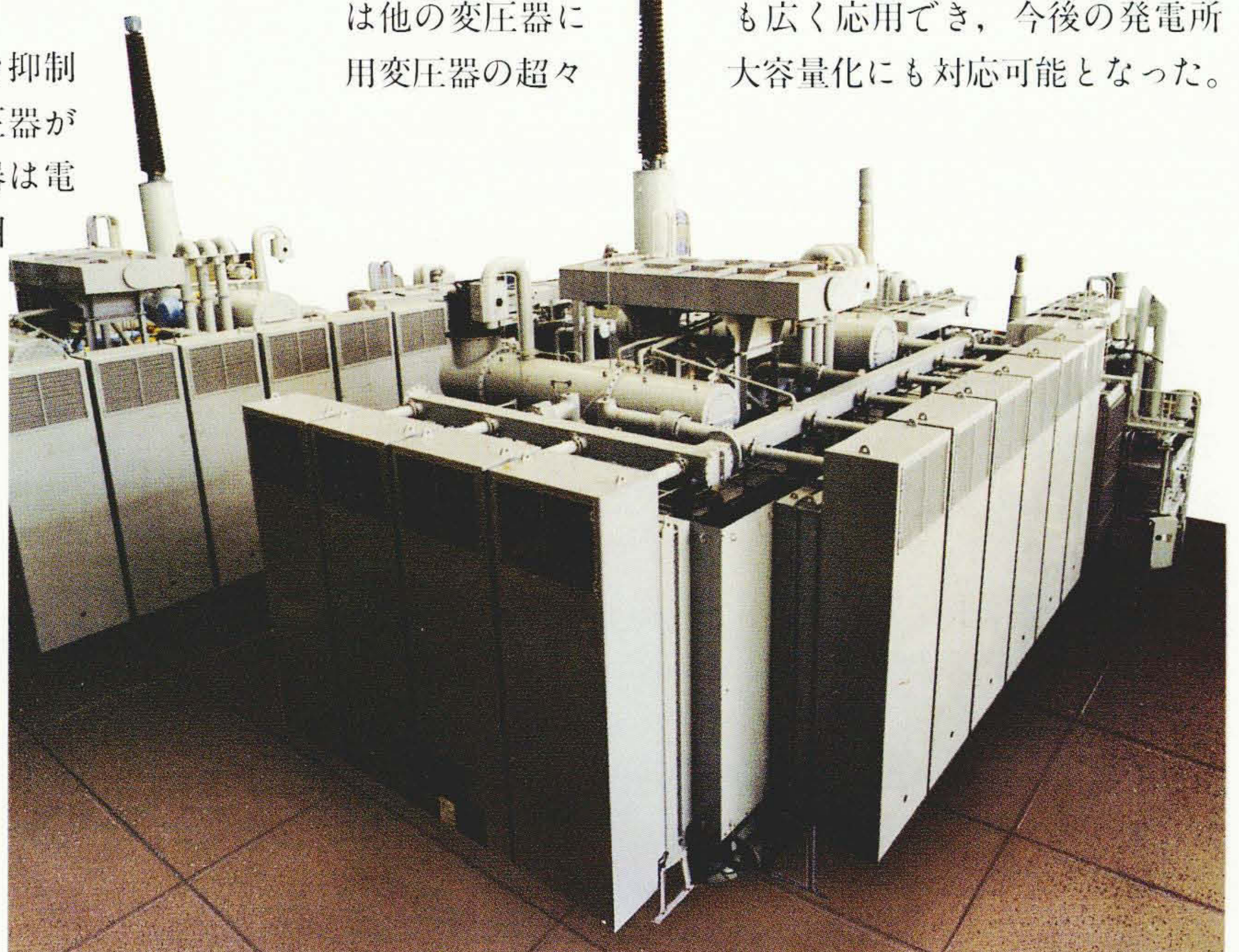
500 kV、1,500 kV/3 MVA高インピーダンス変圧器工場試験
