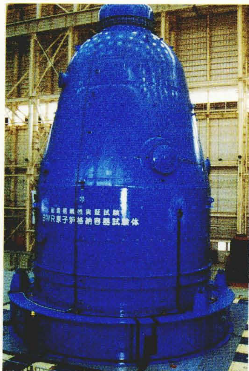
電気出力1,100 MW級 BWR原子炉格納容器試験体 (全高17 m、直径9 m、質量 360 t)
