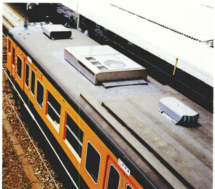
車両用スクロール圧縮機搭載薄形インバータ冷房装置屋根上搭載の例
