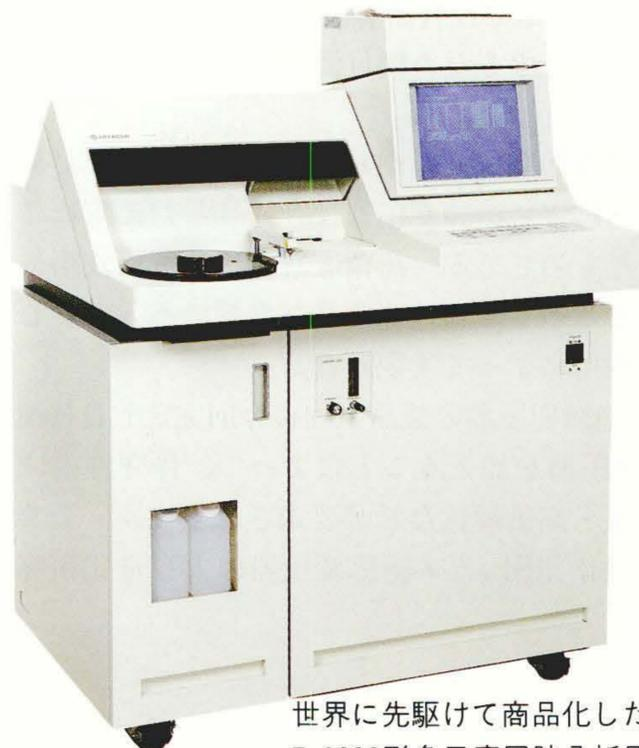
世界に先駆けて商品化した、Z-9000形多元素同時分析原子吸光光度計
