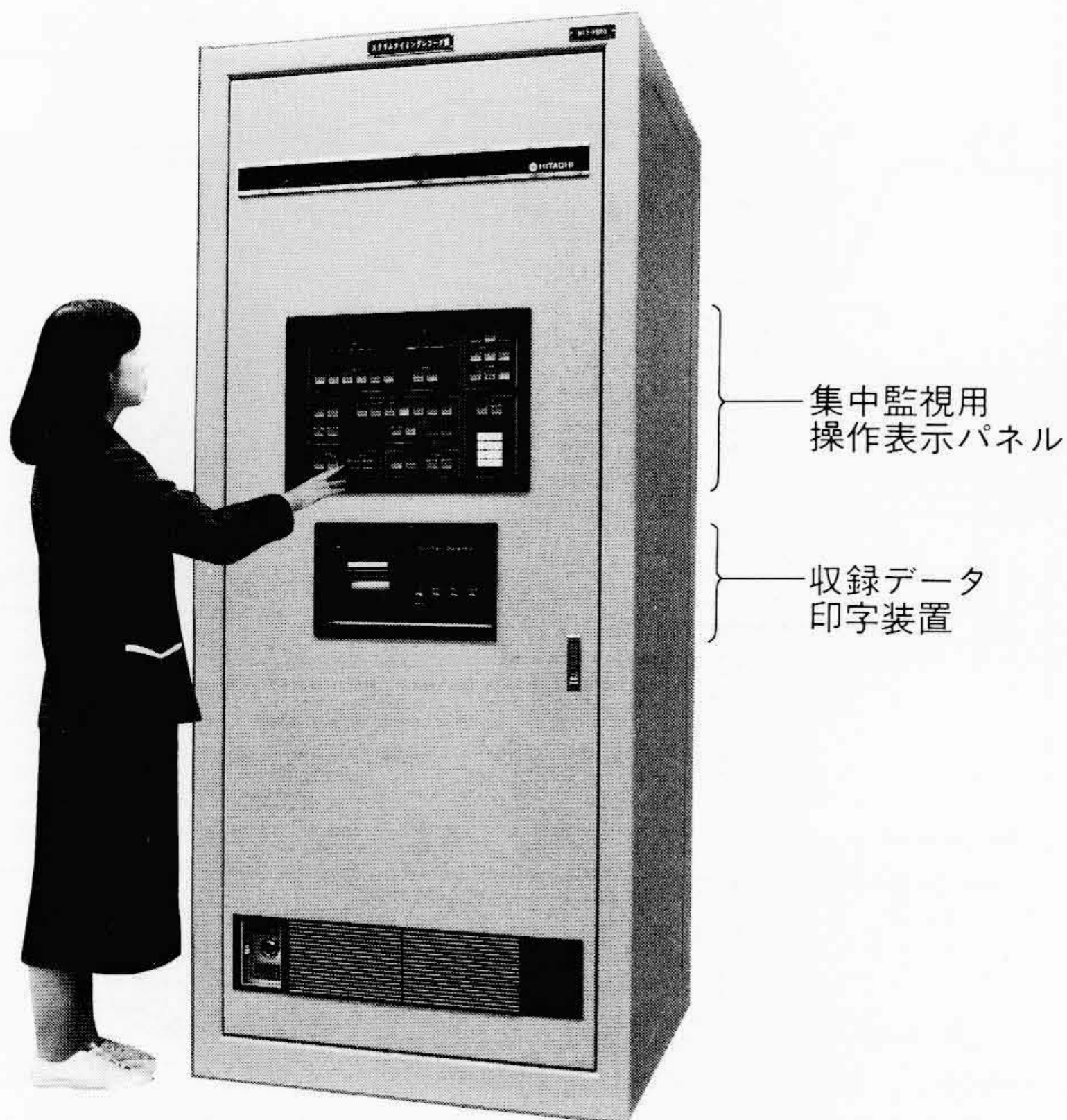
図10 制御棒動作時間記録装置 集中監視用の操作表示パネルと印字装置を前面に設置して、操作・監視の改善を図っている。
