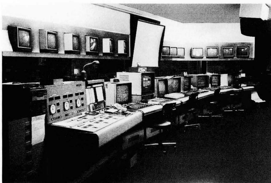
図11 ステッセルミル中央運転室 複数台のインテリジェント運転デスクを切り替えて使用し、ワンマンオペレーションを行っている。
