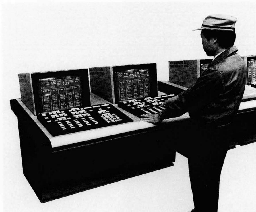
図10 インテリジェント運転デスク CRT(Cathode Ray Tube:画面モニタ)、押しボタンスイッチを用いた運転デスクを示す。
