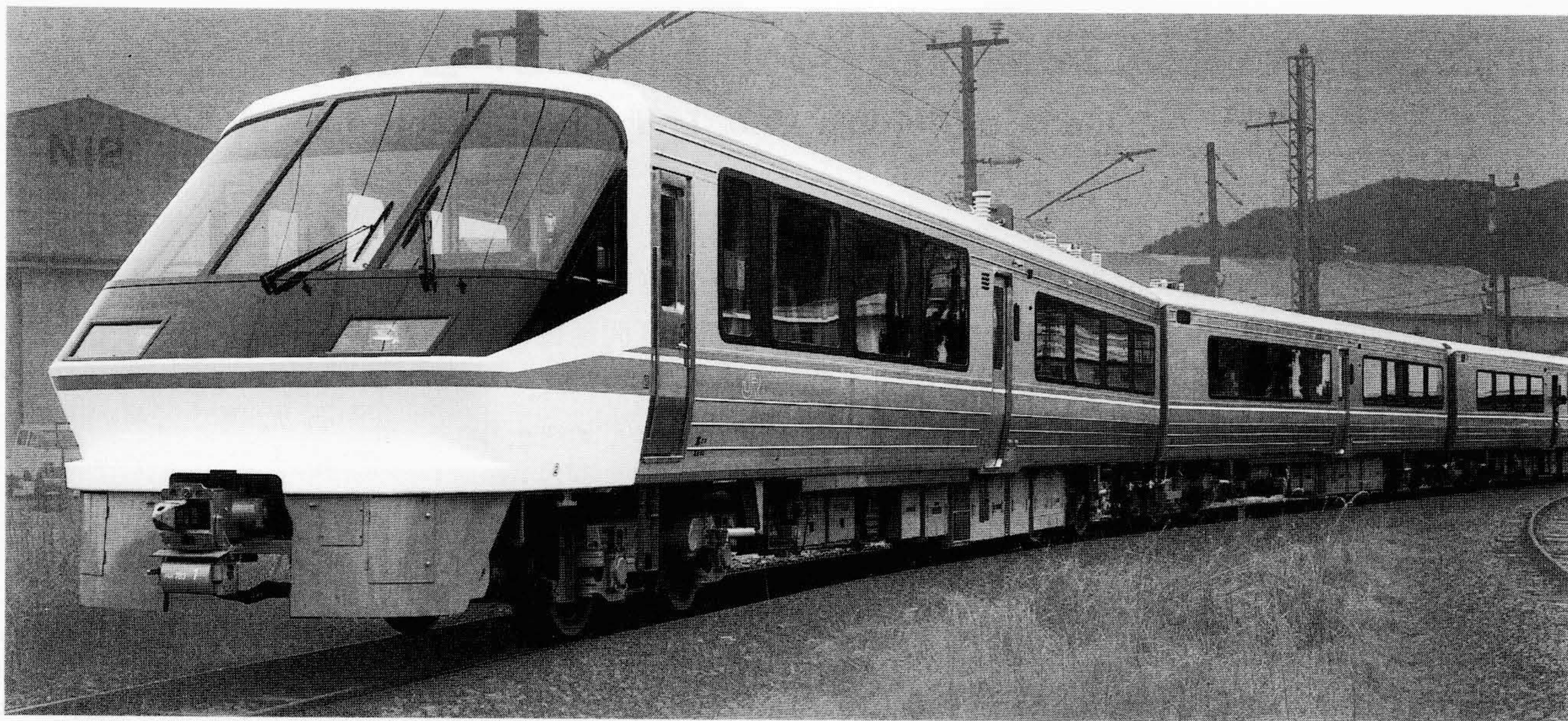
図2 783系新特急電車の外観 スピード感のあふれる先頭形状とし、かつ前方展望を良くした構造とした。
