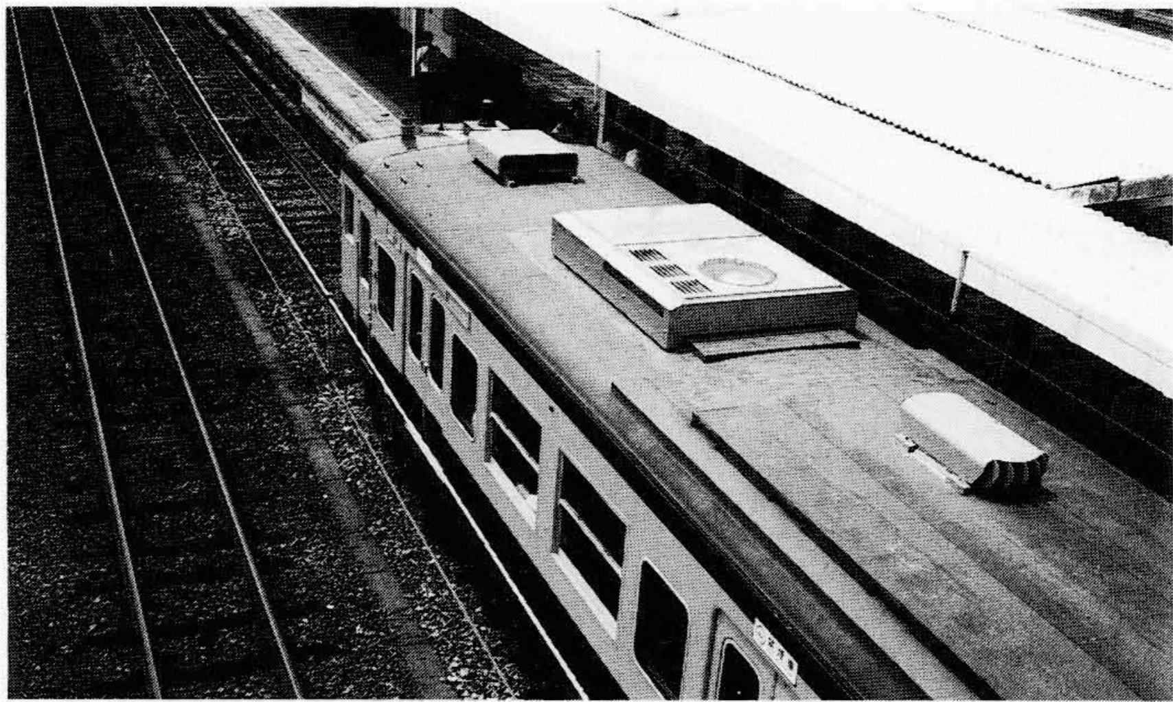
図8 薄形インバータ空調装置の冷房化改造適用例 図7の冷房化改造例による既存車両への適用例を示す。
