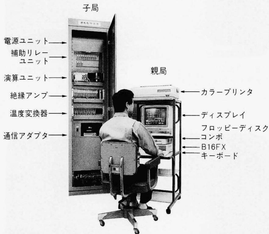
図4 監視システム概観 子局はきょう(筐)体一面に、親局はパーソナルコンピュータラック1台に収められる。
