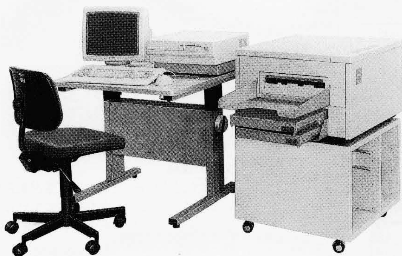
図1 日本語ワードプロセッサ「ワードパルスーパー1000」の外観 図は、本体部、ディスプレイ、入力部(キーボード及びマウス)及びレーザプリンタのコンポーネントから成っている。
